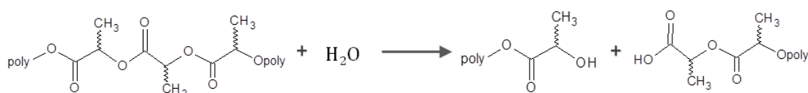
Figura II.7. Escisión de la cadena de PLA debido al efecto del agua durante procesado térmico (adaptado de Carlson y colaboradores 1998[45])
