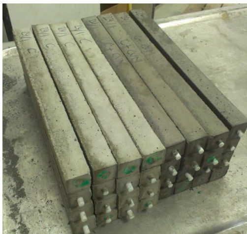
Figura 4.6.1. Probetas 28,5 x 2,56 x 2,56 cm 3 .
