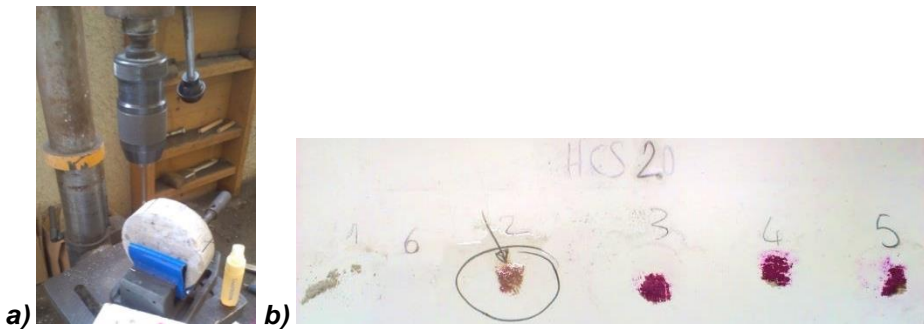
Figura 4.8.16. Sistema de taladro graduado en mm y revelado con fenolftaleína a intervalos de 1 mm.
