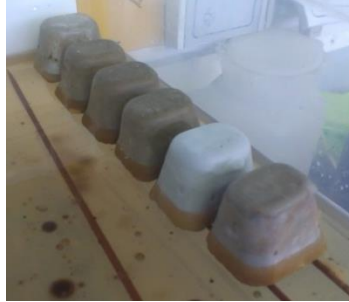
Figura 4.5.3. Pastas de cemento sumergidas en NaCl 1 Molar.
