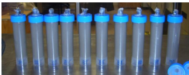
Figura 3.33. Protección del acero expuesto con vaselina.
