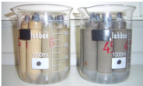
Figura 3.37. Inmersión de las probetas en NaCl 0,5 M.
