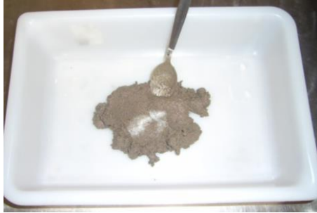
Figura 3.36. Adición de NaCl durante el amasado.
