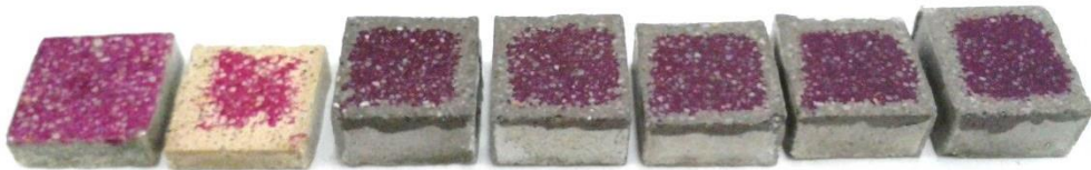
Figura 4.3.1. Frente carbonatado a 7 días, de izquierda a derecha: C, C+F, C+CVBM, C+CVBM+HC5, C+CVBM+HC10, C+CVBM+HC15, C+CVBM+HC20.
