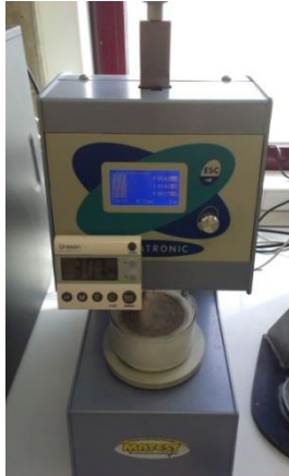
Figura 4.7.1. Aparato de Vicat (automático).
