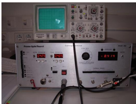
Figura 3.39. Equipos de medida de los parámetros de corrosión.
