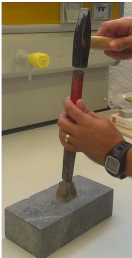
Figura 4.5.4. Rotura en dos de la probeta.
