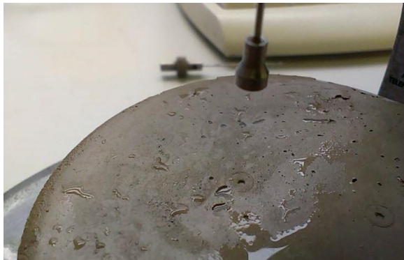
Figura 4.7.2. Aguja Vicat para final de fraguado.
