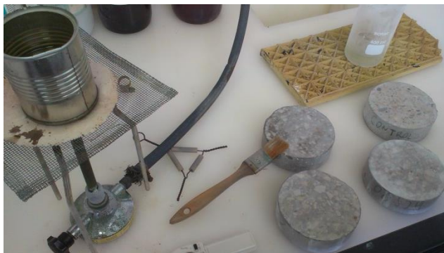
Figura 4.8.15. Proceso de pintado con cera caliente de los discos de hormigón.
