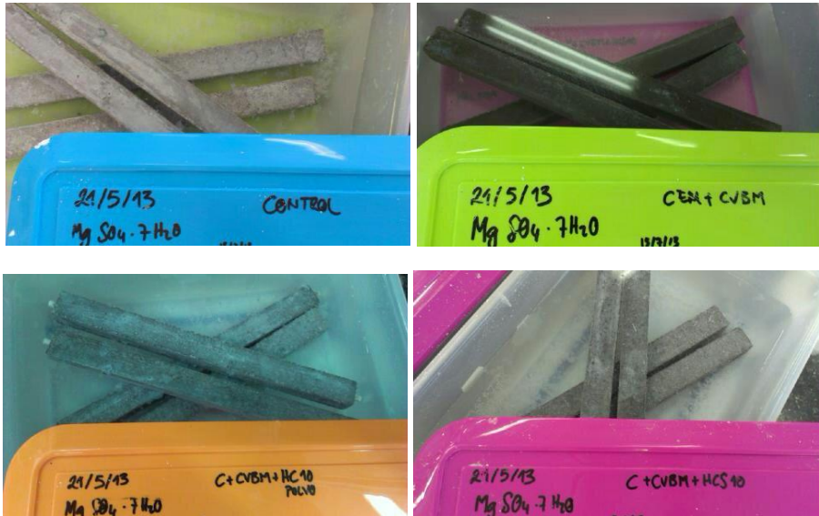
Figura 4.6.6. Formación de producto de lixiviación/reacción en la solución.
