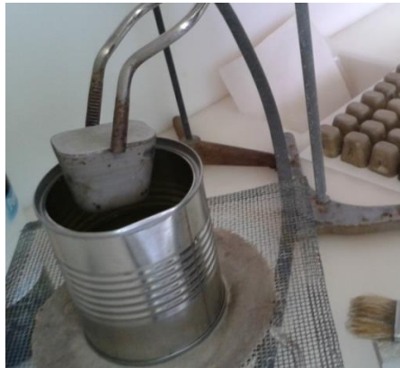
Figura 4.5.2. Proceso de protección de las piezas con cera.
