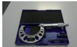
Fig. 97. Micrómetro 50-75 mm
