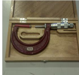
Fig. 95. Micrómetro 25-50 mm
