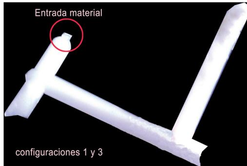
Fig. 52. Bebedero correspondiente a las configuraciones 1 y 3
