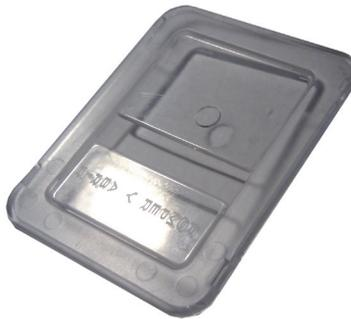
Fig. 131. Pieza validación real 2 inyectada con PS.
