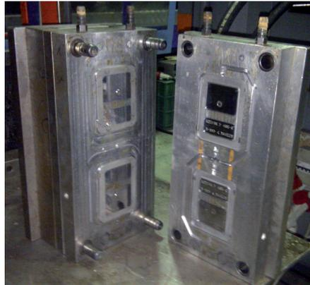
Fig. 132. Molde pieza validación real 2 inyectada con PS.
