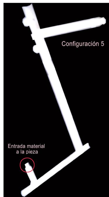
Fig. 55. Bebedero correspondiente a la configuración 5
