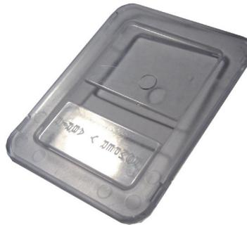
Fig. 88. Pieza real de PS cristal
