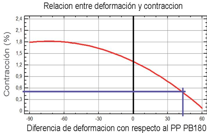
Tabla 83. Obtención gráfica del porcentaje de deformación a compensar en el modelo RNA
