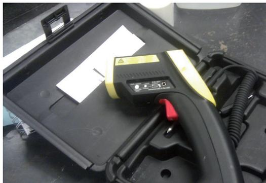
Fig. 93. Pirómetro infrarrojos empleado para medición de la temperatura del molde y de la masa fundida
