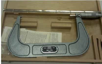
Fig. 94. Micrómetro 75-100 mm
