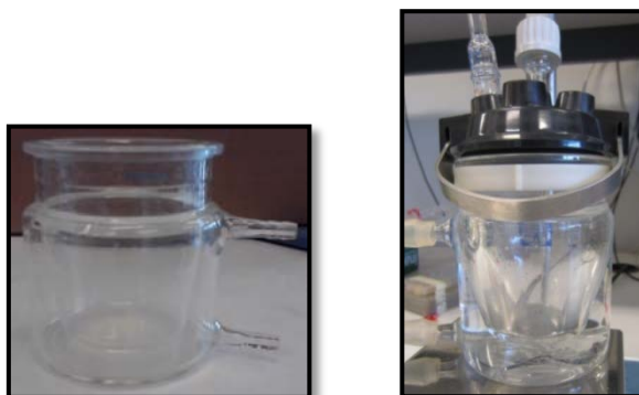
Imagen 1.16. Celda electroquímica. (Fuente Propia)
