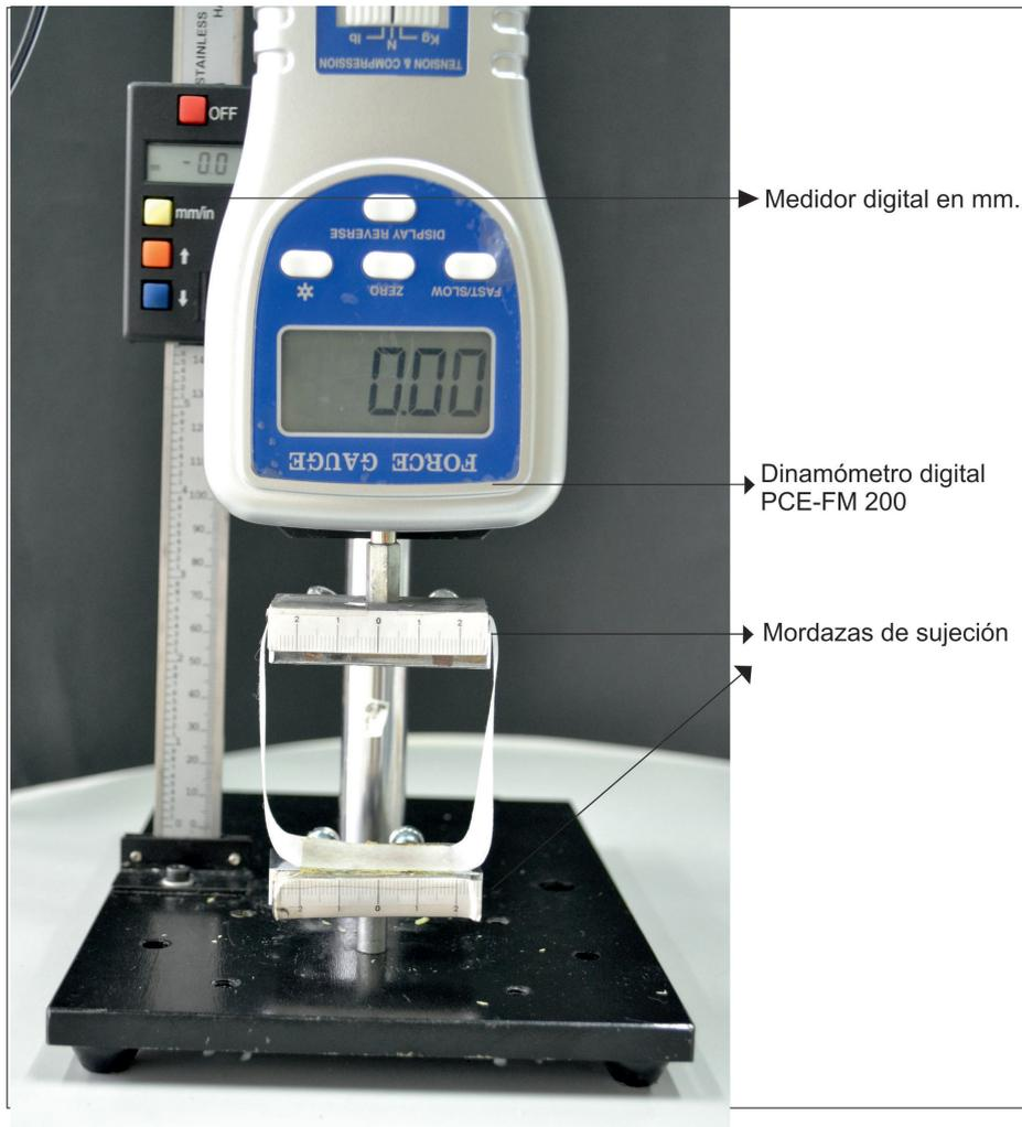
Imagen 33. Dinamómetro utilizado.
