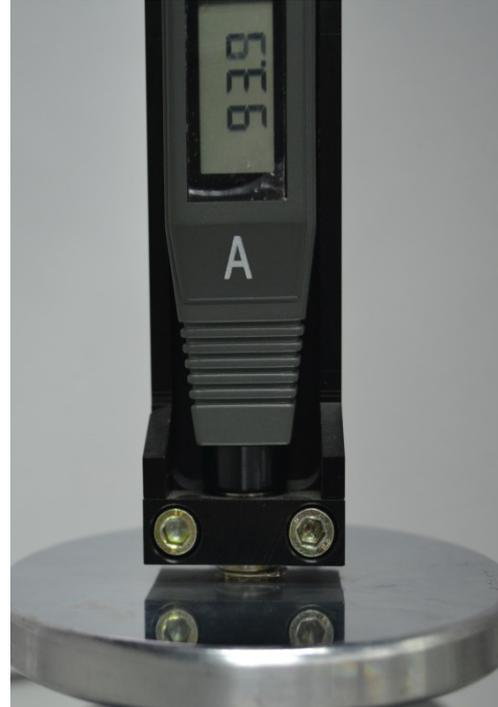
Imagen 17. Medición de dureza G. Técnica.
