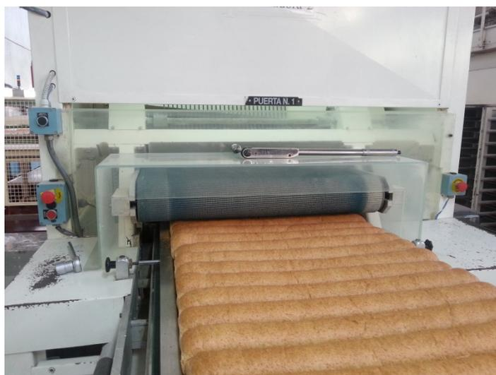
Figura 13. Entrada del pan en la cabina de rebanado
