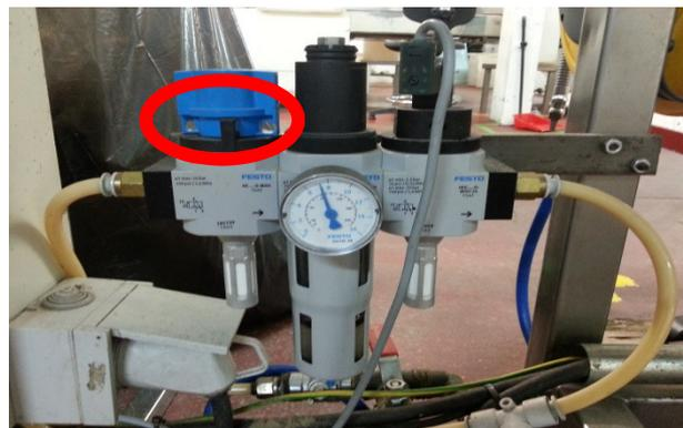
Válvula de corte de energía neumática instalada en diversas máquinas de la fábrica, que permite consignarla.
