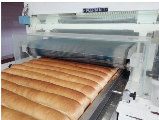
Carcasa de protección insuficiente, por tener muy poca longitud y dejar accesible el rodillo
