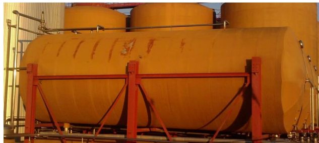
Figura 4.3. Tanque de fermentación horizontal
