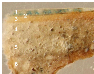
Fig.52: Muestra del retablo de la Purísima , estratos de preparación y p.p. de azurita.
