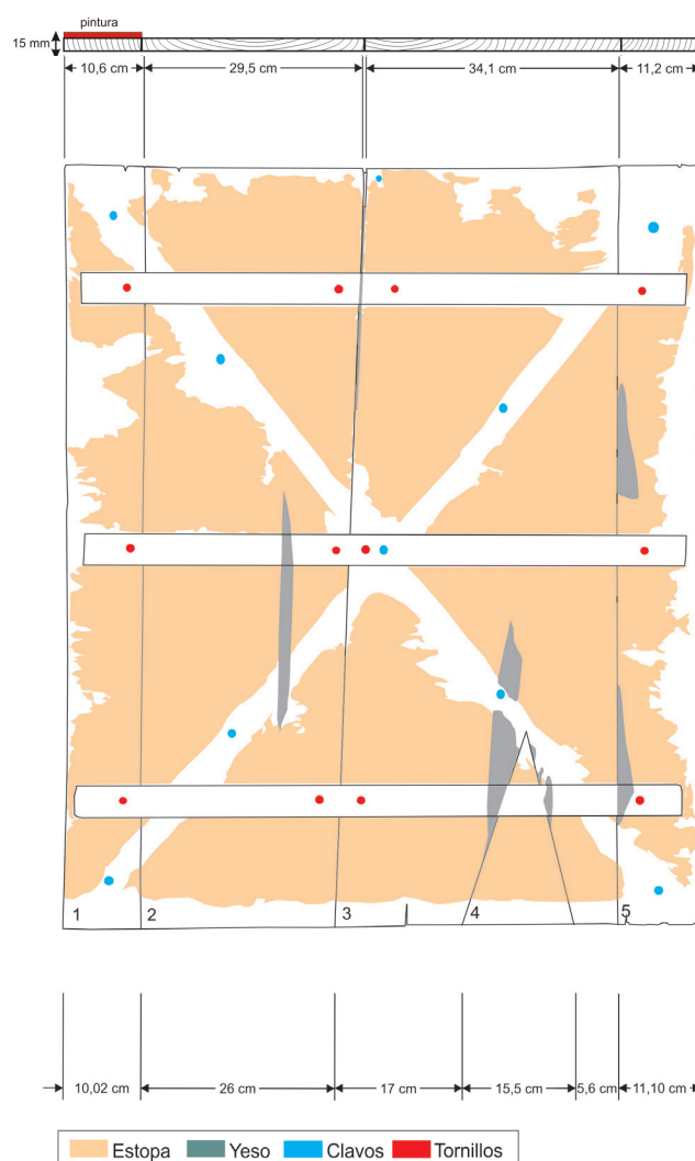
Fig. 37: Diagrama de construcción del soporte.
