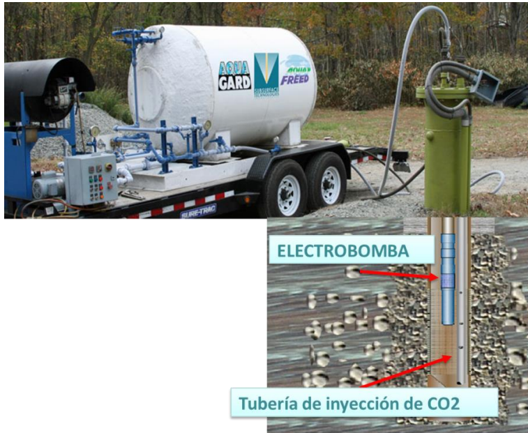
Figura 7. Esquema operativo del sistema Aqua Gard®
