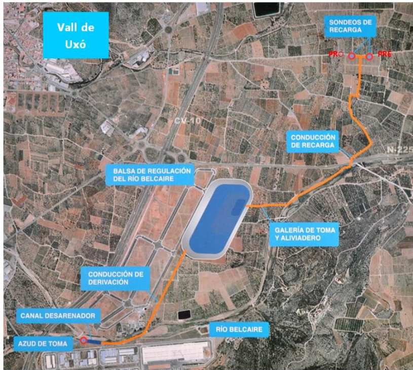
Figura 3. Esquema general de las instalaciones de recarga
