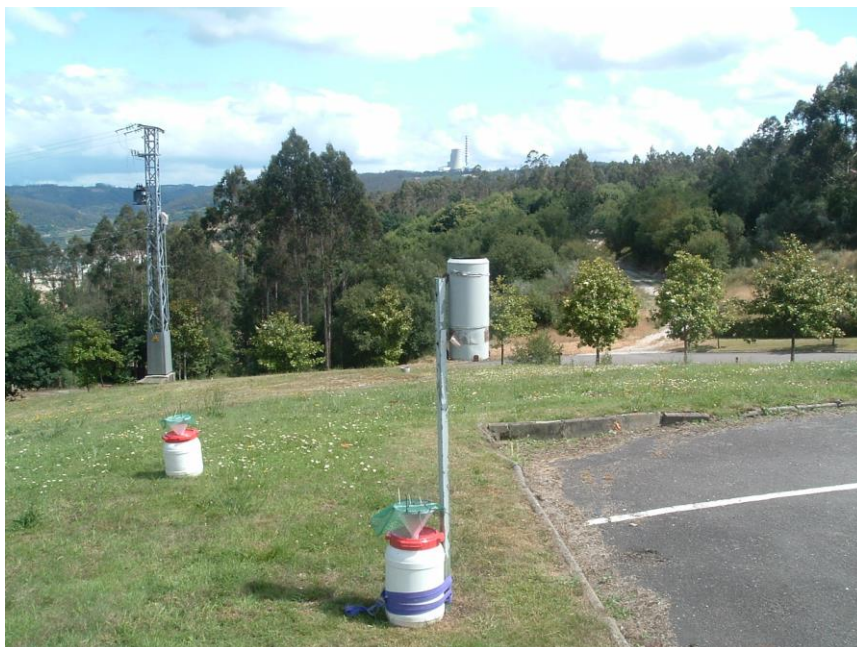
Figura 1. Depósito recolector de precipitación bruta instalado en campo.
