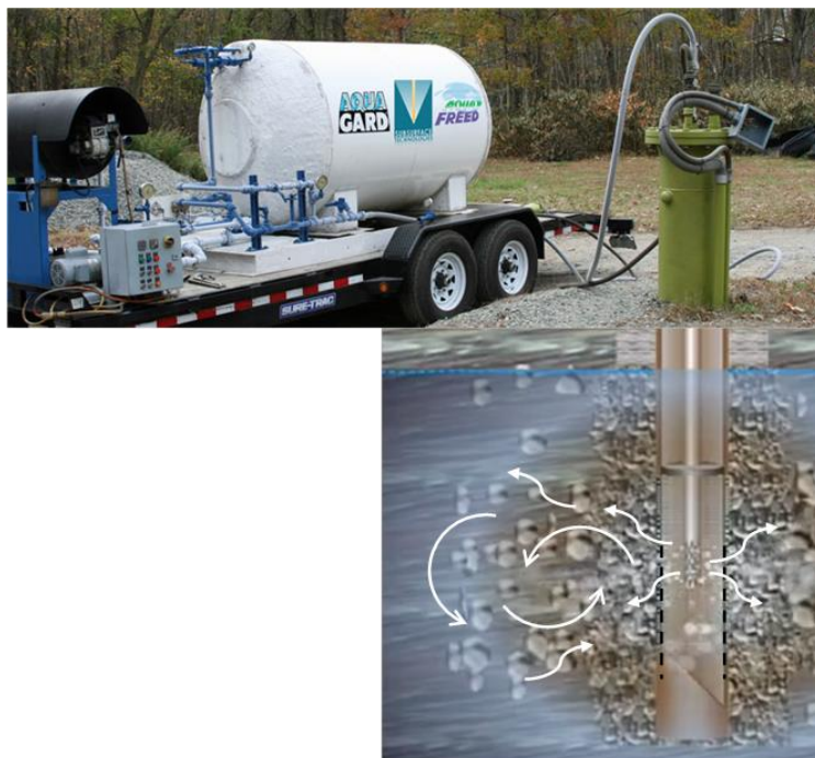
Figura 5. Equipo de inyección Aqua Freed ® conectado a cabezal de pozo
