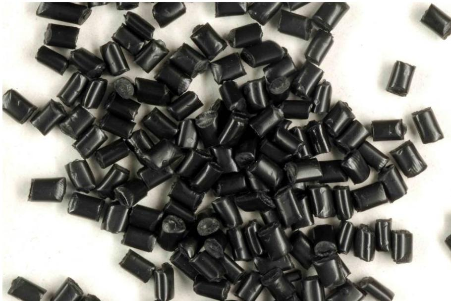
Figura IV. 2-12. Imagen de la granza obtenida de las mezclas de PP reciclado y PP ISPLEN® PB 140 G2M
