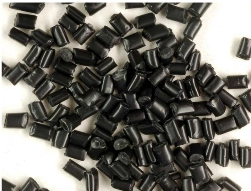
Figura IV. 2-29.Imagen de la granza obtenida de las mezclas de de PP reciclado y HDPE ALCUDIA® C-20.
