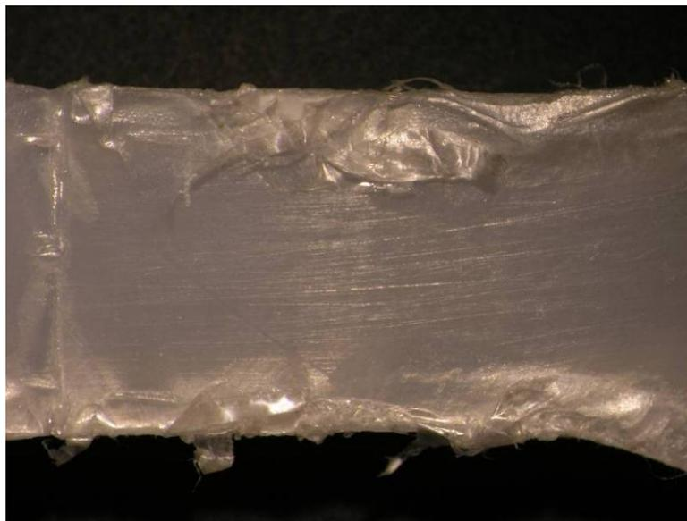
Figura IV. 3-3. Detalle del efecto de deslaminación en la superficie de la muestra con un 15% de HDPE.
