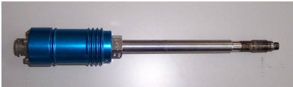
Figura III. 4-5. Transductor de presión utilizado
