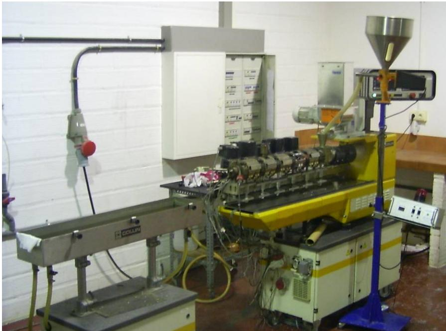
Figura III. 1-1. Extrusora de doble husillo utilizada para la preparación de mezclas
