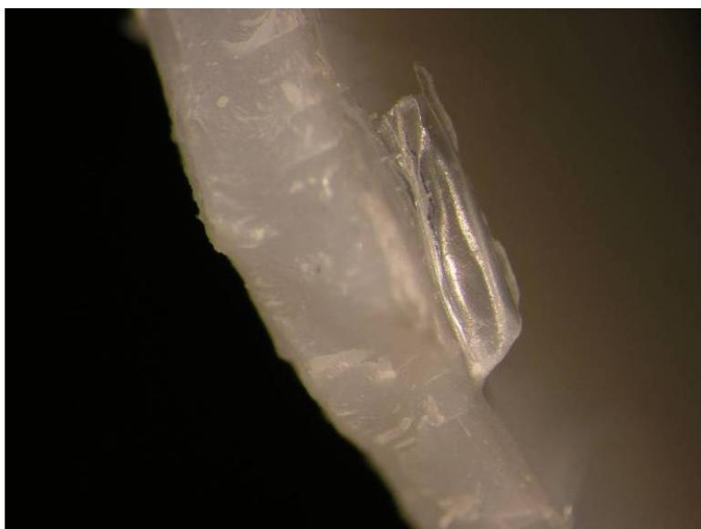
Figura IV. 3-2. Detalle del efecto de deslaminación en la sección de la muestra con un 15% de HDPE.
