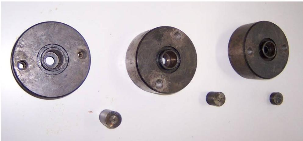
Figura III. 4-4. Soportes y boquillas de diferentes relaciones L/D (30, 20, 10)
