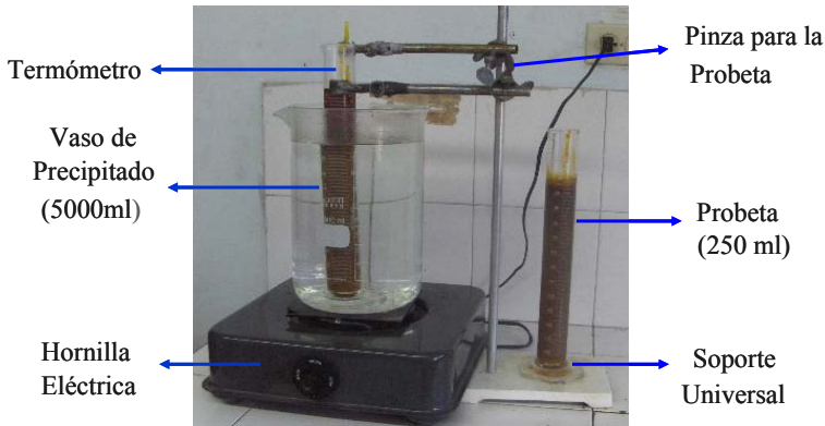
Fig. 7.6 Montaje para las pruebas de sedimentación
