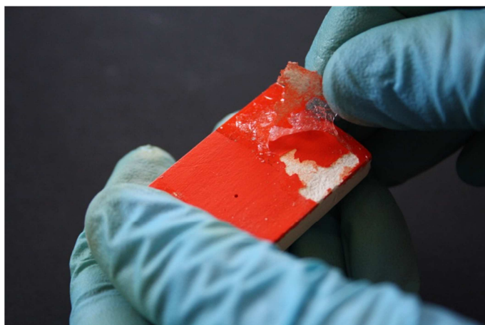
Figura 11. Retirada del espessidor de la superfície de la proveta
