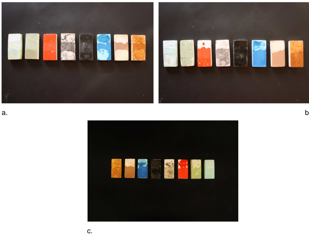
Figura 171. Resultat aplicació Pectina® (a.6 hores, b. 12 hores, c. 24 hores)
