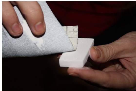
Figura 2. Provetes passada pel paper de polir.
