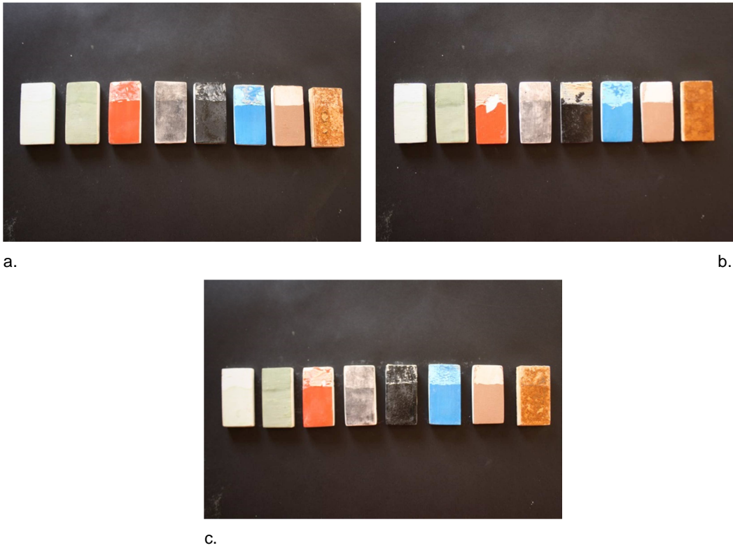
Figura 172. Resultat aplicació Beta 1,3 Glucans® (a.6 hores, b. 12 hores, c. 24 hores)
