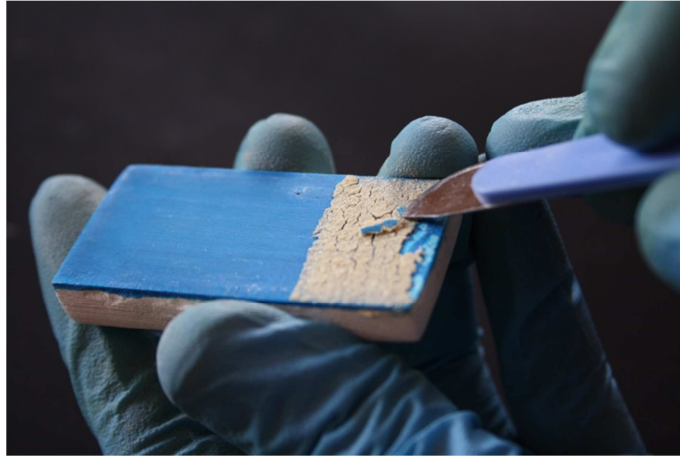
Figura 13. Retirada del espessidor de la superfície de la proveta
