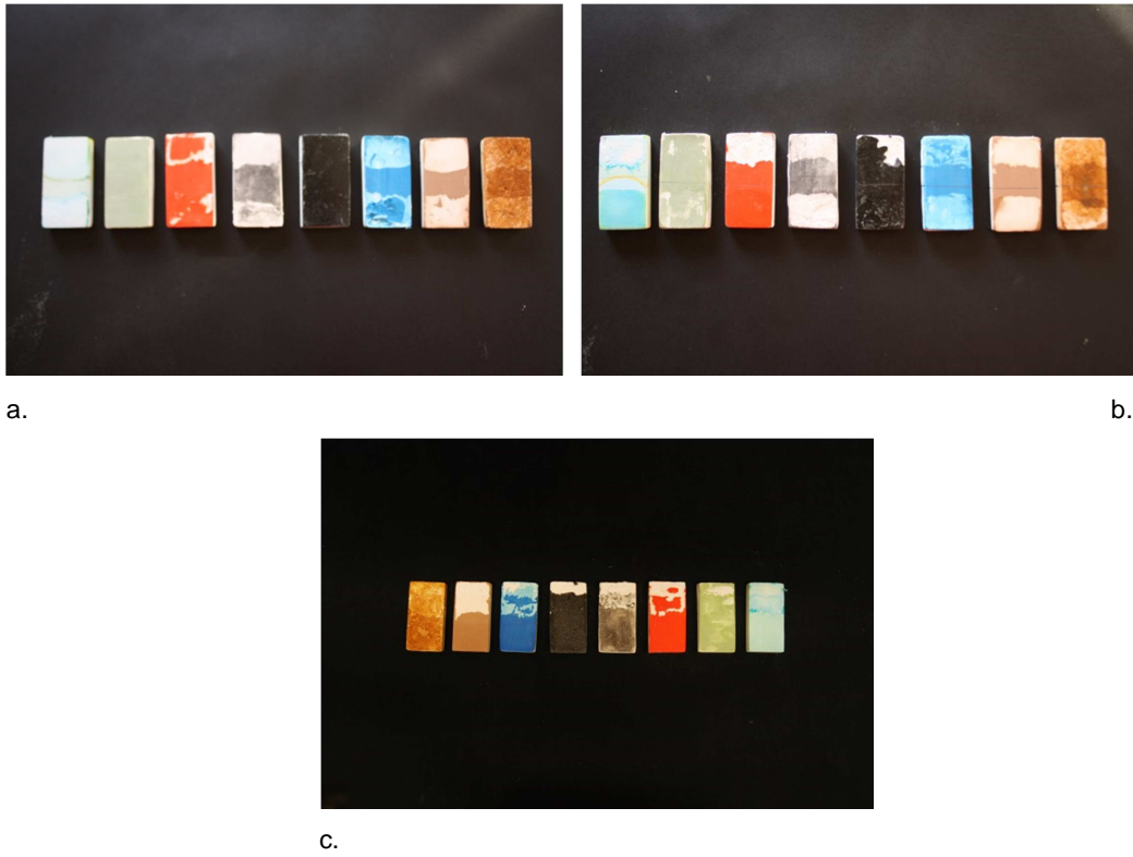
Figura 170. Resultat aplicació Resource Espesante® (a.6 hores, b. 12 hores, c. 24 hores)
