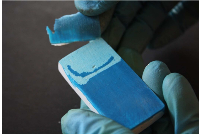
Figura 10. Retirada del gel de la superfície de la proveta
