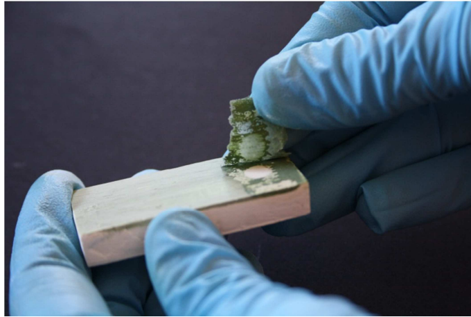
Figura 9. Retirada del gel de la superfície de la proveta
