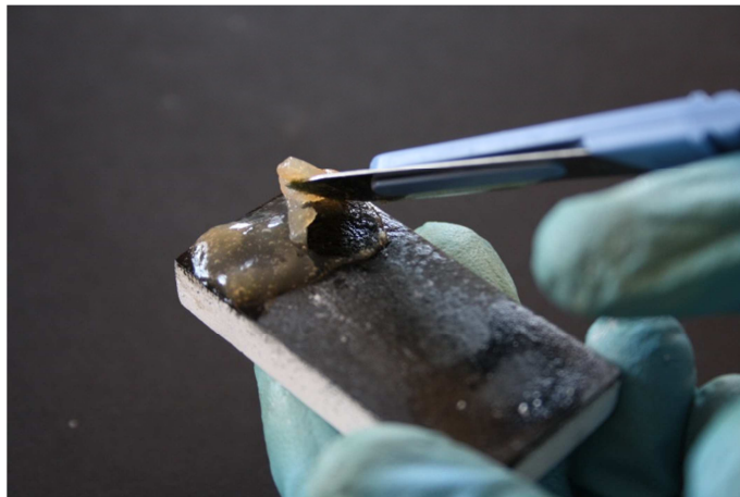
Figura 12. Retirada del espessidor de la superfície de la proveta
