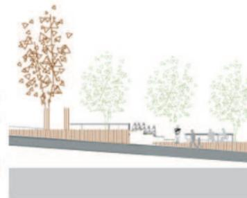
luz perimetral: luminarias empotradas en la parte superior de los zocalos de acero corten, la iluminación en dirección al propio muro, enfatiza el propio objeto arquitectónico
