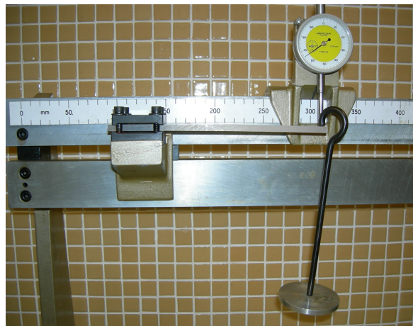
Figura 3.5. Montaje experimental para la determinación del módulo de Young mediante ensayo de flexión.
