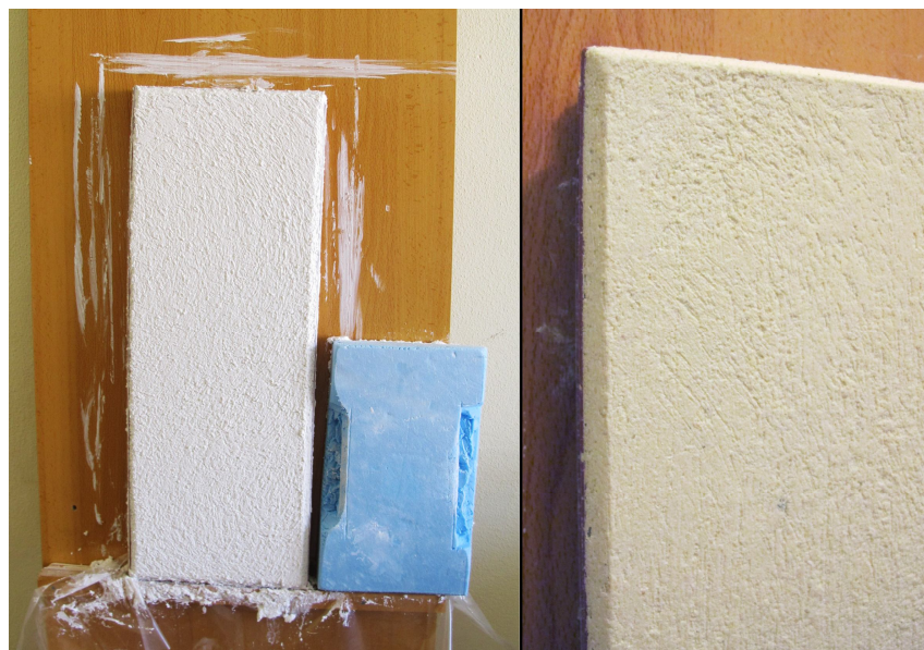
Imagen 41. A la izquierda vemos el proceso de fratasado con fragmento de poliestireno extruido tras la primera capa. A la derecha, en detalle se aprecia como se le da forma a las aristas de la probeta, biselándolas.
