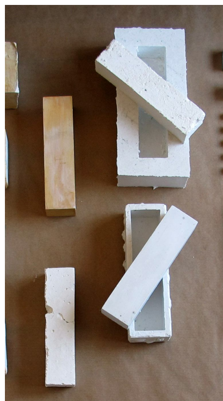
Imagen 2. Detalle de los dos primeros moldes obtenidos con la silicona Idesil 801.
