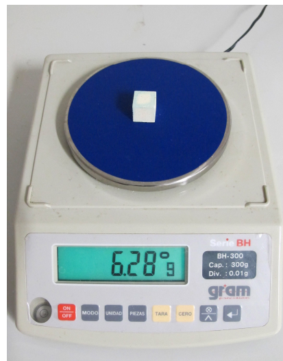
Imagen 18. En la imagen vemos el proceso de pesado de las probetas.
