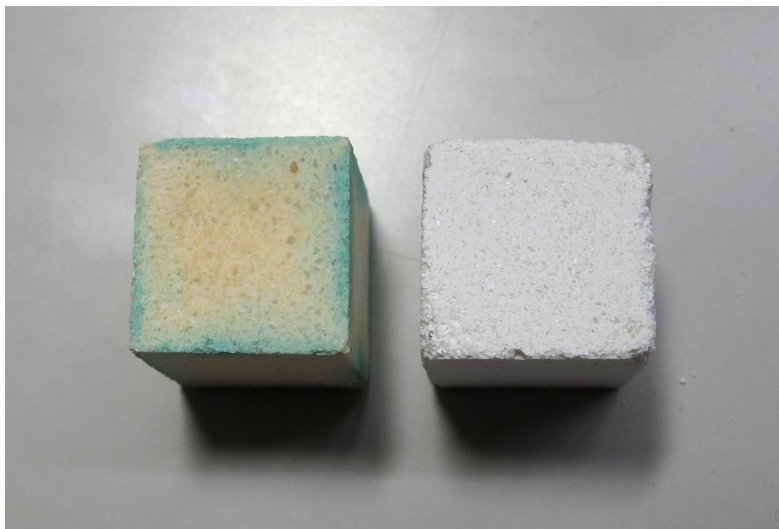
Imagen 17. Probeta del mortero Unicmall® sometida a la cámara de SO 2 a la izquierda y la probeta del mismo mortero de control a la derecha.
