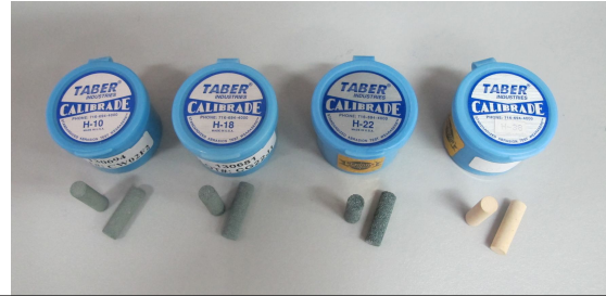
Imagen 64. Detalle de los tacos abrasivos duros, de menor a mayor dureza. El de la derecha es el único que no contiene carga de resina.
