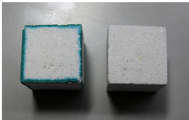
Imagen 34. Probeta del mortero creado con la cal Gordillo's ® expuesta en la cámara climática a la izquierda y la probeta del mismo mortero de control a la derecha.
