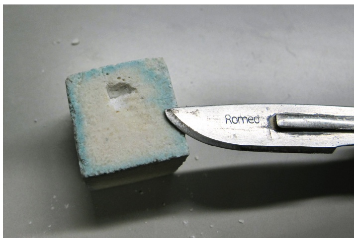
Imagen 19. Detalle de la erosión y horadado de las probetas, comparando su resistencia con las de control.
