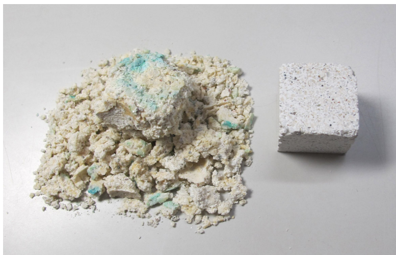
Imagen 13. Probeta del mortero Maltamix TG ® sometida a la cámara de SO 2 a la izquierda y la probeta del mismo mortero de control a la derecha.
