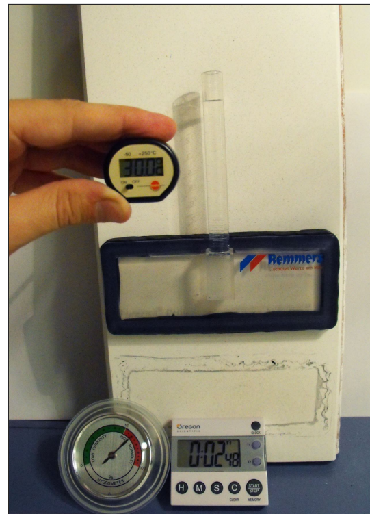
Imagen 59. Medición de la HR, temperatura de la superficie por contacto y tiempo, durante la segunda medición (aún se aprecia la huella del adhesivo de la primera prueba)
