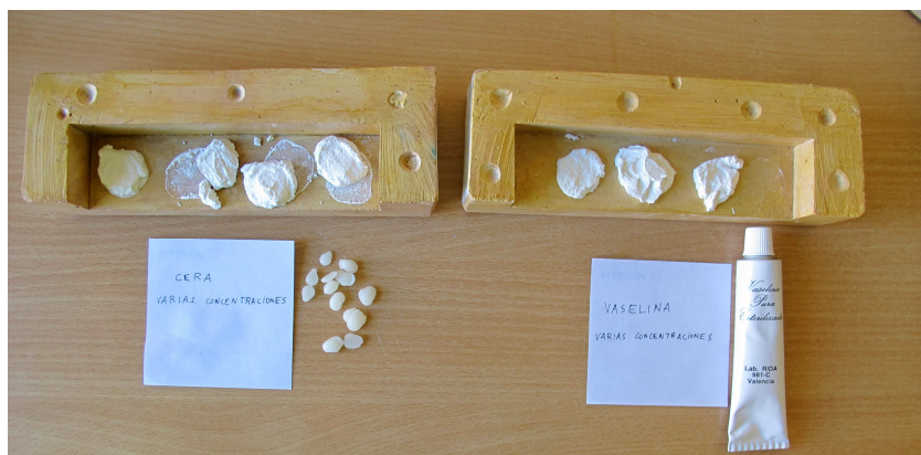
Imagen 3. Detalle de las pruebas de desmoldantes sobre escayola consolidada con goma laca. A la derecha, las aplicaciones de mortero de cal se despegan sin dejar restos, como ocurre a la izquierda con la cera.
