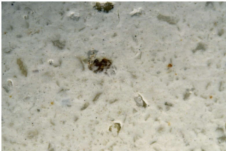
Imagen 47. En esta fotografía al microscopio vemos en detalle la superficie pulimentada del estuco confeccionado con mortero Unicmall.
