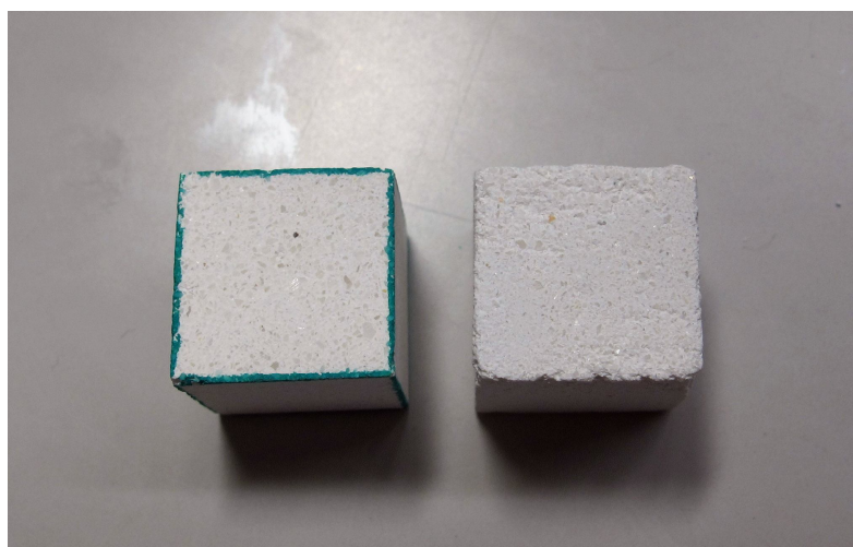
Imagen 33. Probeta del mortero realizado con Punto Cal ® expuesta en la cámara climática a la izquierda y la probeta del mismo mortero de control a la derecha.
