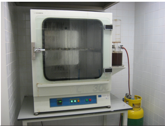
Imagen 11. En la foto se muestra la cámara para ensayos de corrosión por SO 2 Dycometal modelo VCK-300. Imagen: Web del Instituto de Restauración del Patrimonio. UPV
