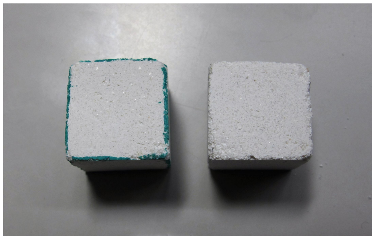
Imagen 35. Probeta del mortero realizado con Unicmall® expuesta en la cámara climática a la izquierda y la probeta del mismo mortero de control a la derecha.
