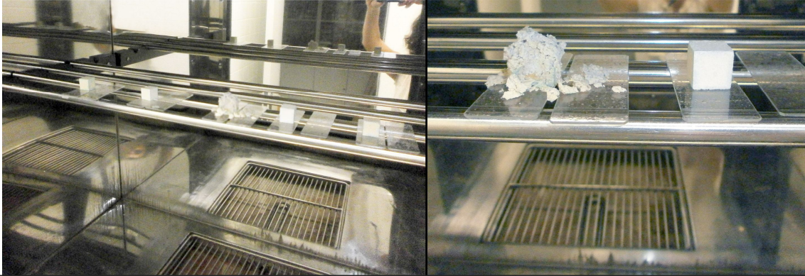
Imagen 12. Interior de la cámara para el ensayo de corrosión por SO 2 . En la imagen de la izquierda vemos las cinco probetas y a la derecha, un detalle de la probeta que ha sufrido mayor degradación. Imágenes: M a Antonia Zalbidea Muñoz.
