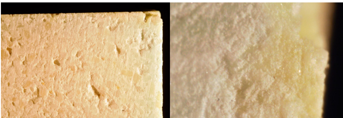
Imagen 23. Estas dos fotografías adicionales pertenecen a la cara de la probeta expuesta a SO_2 donde se realizó la sección, una visión general a bajo aumento a la izquierda y la misma zona, pero en su perímetro, a la derecha con el máximo aumento.
