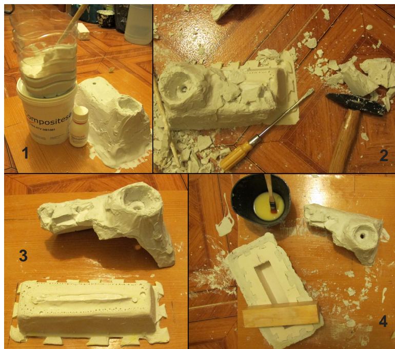
Imagen 7. En la primera foto, se ve la preparación para el vertido de la silicona ya catalizada, la ruptura del contramolde por la imposibilidad de extraerlo, pues no se aplicó desmoldante. En la foto 4, se aprecia el desmoldante utilizado.
