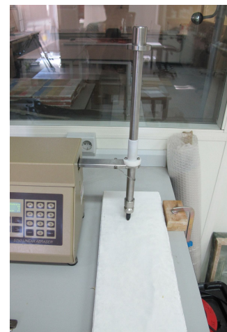
Imagen 62. Detalle de la barra vertical que apoya su peso libre sobre la superficie de contacto.
