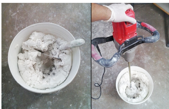
Imagen 2. En esta imagen podemos ver el proceso de mezclado y batido para la extracción de una muestra de mortero fresco.
