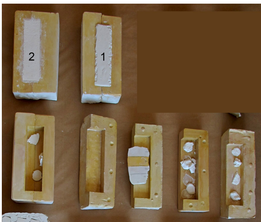
Imagen 4. Visión general de todos los moldes "bi-piezas" creados (5 en total). El número 1 corresponde al vertido de escayola en el interior del molde y el nº 2 corresponde al vertido de mortero de cal con la dosificación seleccionada c/a 2:1.
