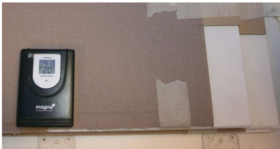
Imagen 49. Detalle del interior de la cámara, donde se encuentra el termohigrómetro.
