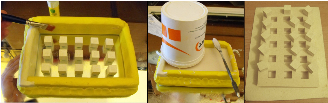
Imagen 10. Proceso de realización de uno de los moldes. Primero se colocan las piezas sobre la superficie plana con ligera adhesión y se aíslan las superficies con vaselina. Aplicación por vertido de la silicona catalizada y resultado, extrayendo los prismas de escayola.
