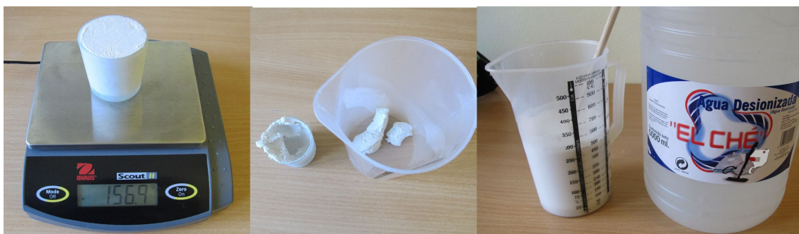
Imagen 3. Pesado del mortero en estado fresco inicial - Vertido del mortero en recipiente mayor para su mezcla con agua - Suspensión con agua desionizada.
