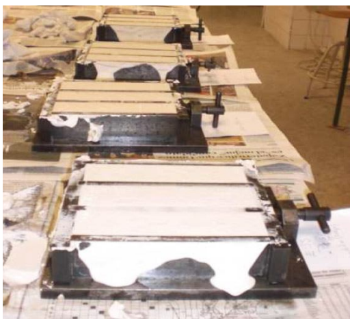
Imagen 7. LLAURADÓ PÉREZ, Nuria. "Vaciados de escayola y corridos de terraja en obras de restauración". Detalle de un tipo de molde metálico, durante la realización de probetas de yeso.
