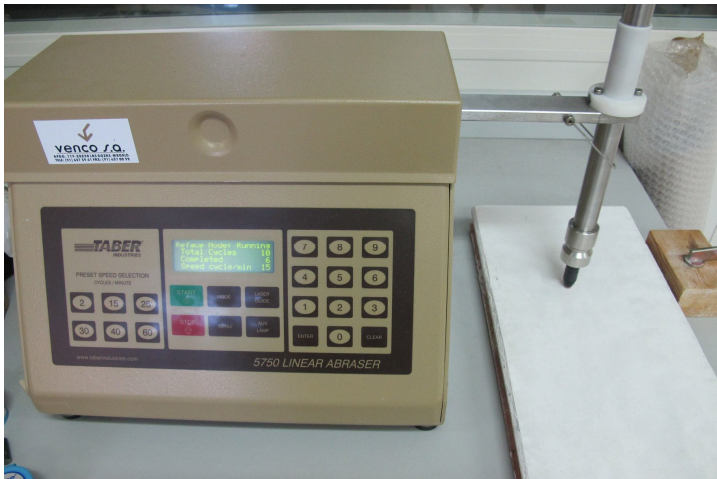
Imagen 61. Abrasímetro lineal durante el ensayo sobre una de las probetas. El movimiento del brazo horizontal es de izquierda a derecha con una distancia entre un punto y otro aproximadamente de 5 cm.
