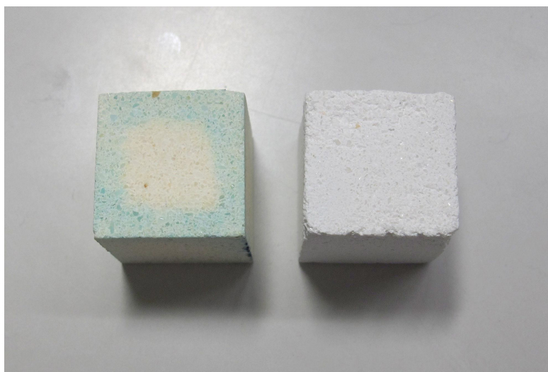
Imagen 15. Probeta del mortero Punto Cal® sometida a la cámara de SO 2 a la izquierda y la probeta del mismo mortero de control a la derecha.
