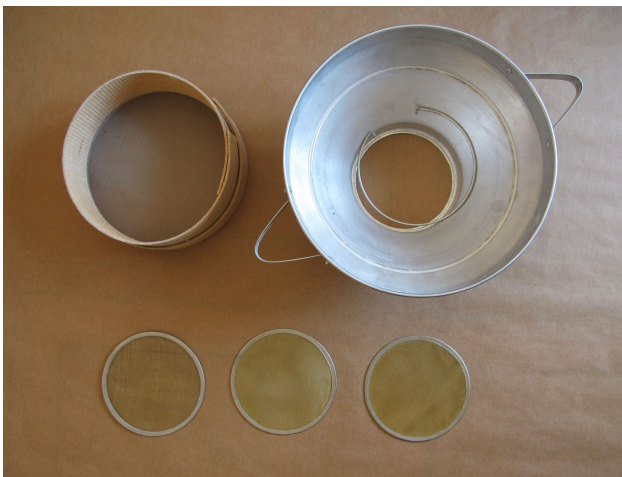
Imagen 4 . Mostramos los tamices con diferente diámetro de malla utilizados en la caracterización del Maltamix TM®
