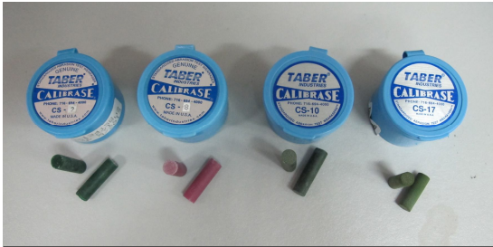
Imagen 63. Detalle de los tacos o puntas abrasivas blandas, ordenadas de izquierda a derecha de menor a mayor dureza. El de la izquierda es el único que no contiene partículas de abrasivo.
