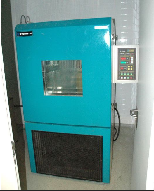
Imagen 30. En la foto se muestra la cámara para ensayos de corrosión por SO 2 Dycometal modelo VCK-300. Imagen: Web del Instituto de Restauración del Patrimonio. UPV
