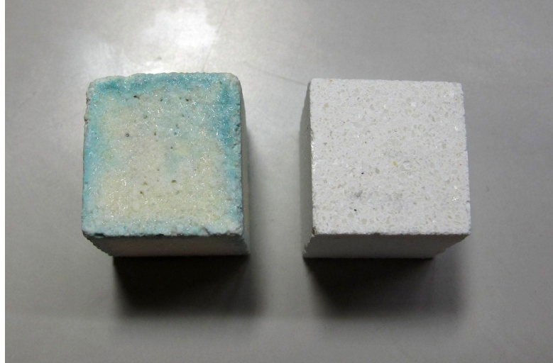
Imagen 16. Probeta del mortero Gordillo's® sometida a la cámara de SO 2 a la izquierda y la probeta del mismo mortero de control a la derecha.
