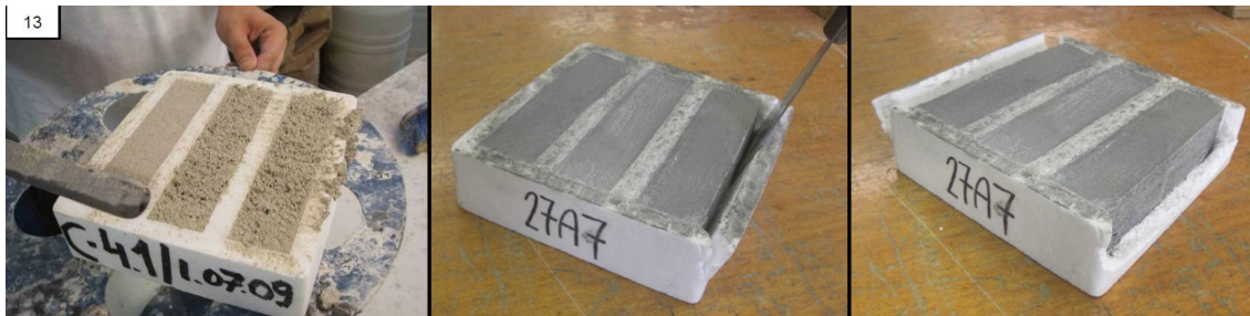
Imagen 6. 1ª: RIERA JUAN, Santiago; GONÇALVES SOARES, Miguel Angelo. "Análisis comparativo experimental de algunos morteros de restauración". 2ª y 3ª fotografía: JAIME GIMÉNEZ, Ana. "Estudio del efecto de aditivos y adiciones en las propiedades físicas y mecánicas de los morteros". En estas imágenes vemos, respectivamente de izda. a drcha., el enmoldado del mortero sobre la mesa de sacudidas, la rotura del molde tras el curado y un detalle de la rotura del mismo previa a la extracción; usando en los tres casos moldes de poliestireno expandido.
