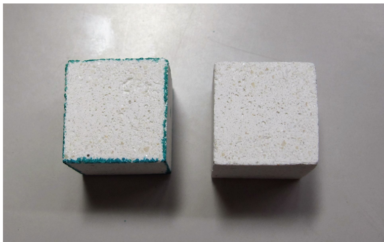
Imagen 32. Probeta del mortero Maltamix TG ® expuesta en la cámara climática a la izquierda y la probeta del mismo mortero de control a la derecha.
