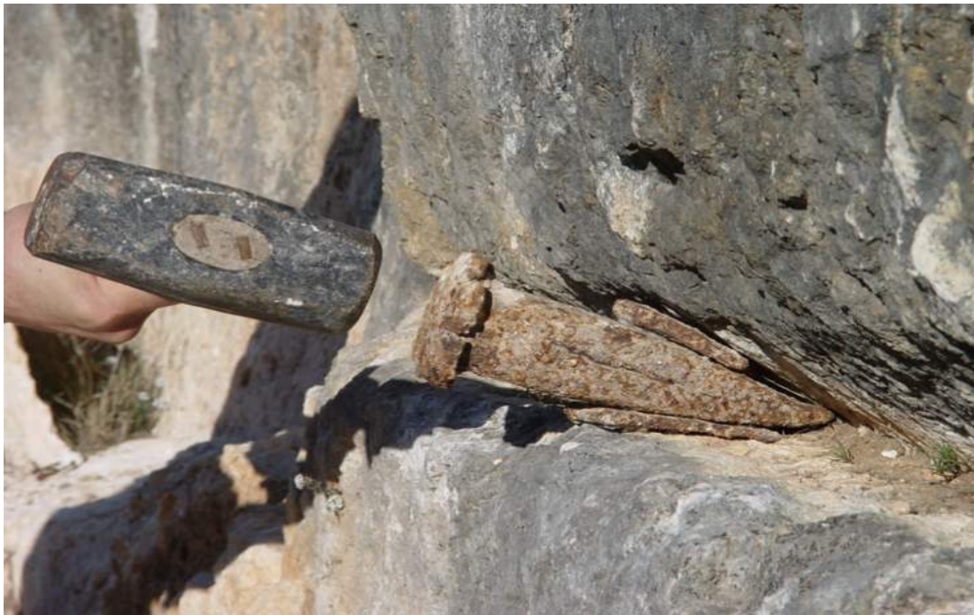
Reconstrucción del momento en que se golpeaba, con la maza de hierro, la cuña (esta cuña de la imagen no ha sido golpeada...)
