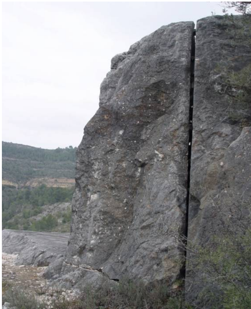
Corte con hilo de diamante buscando escuadrar un bloque quitando sobrante.
