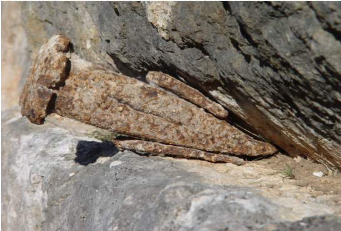
Cuña romana y sobrecuñas de Enova, colocadas tal como lo fueron en época Imperial.
