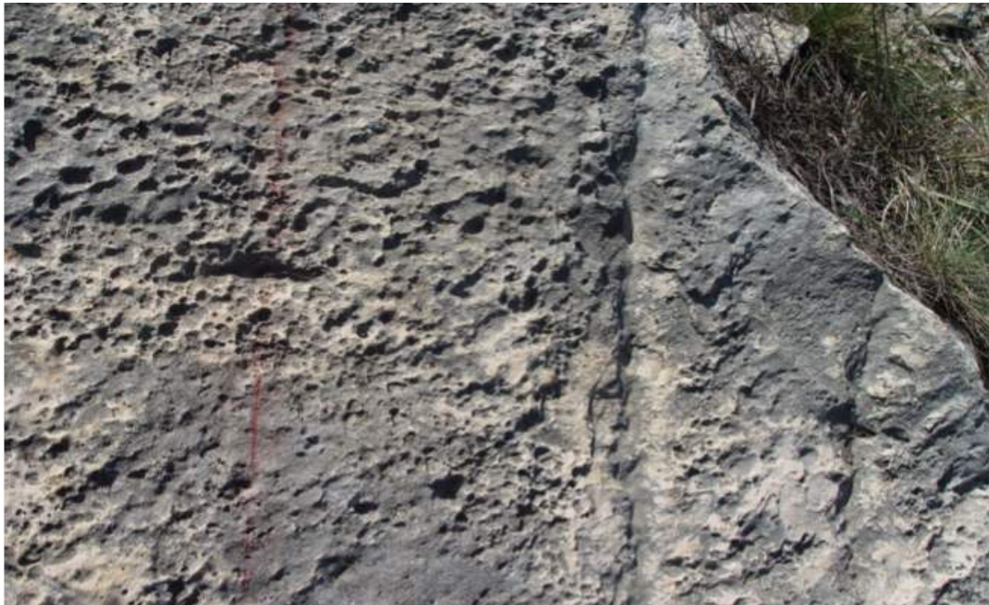
Marca roja de la cuerdecilla al golpear en la superficie de la roca.
