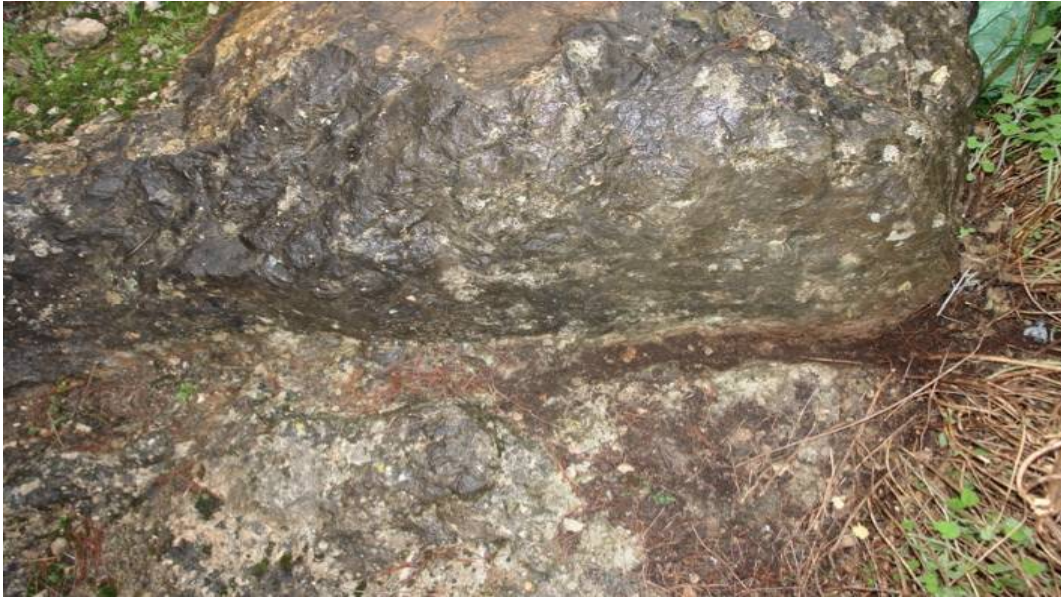
Imagen de una enclava para sacar un bloque en la pedrera de Godella
