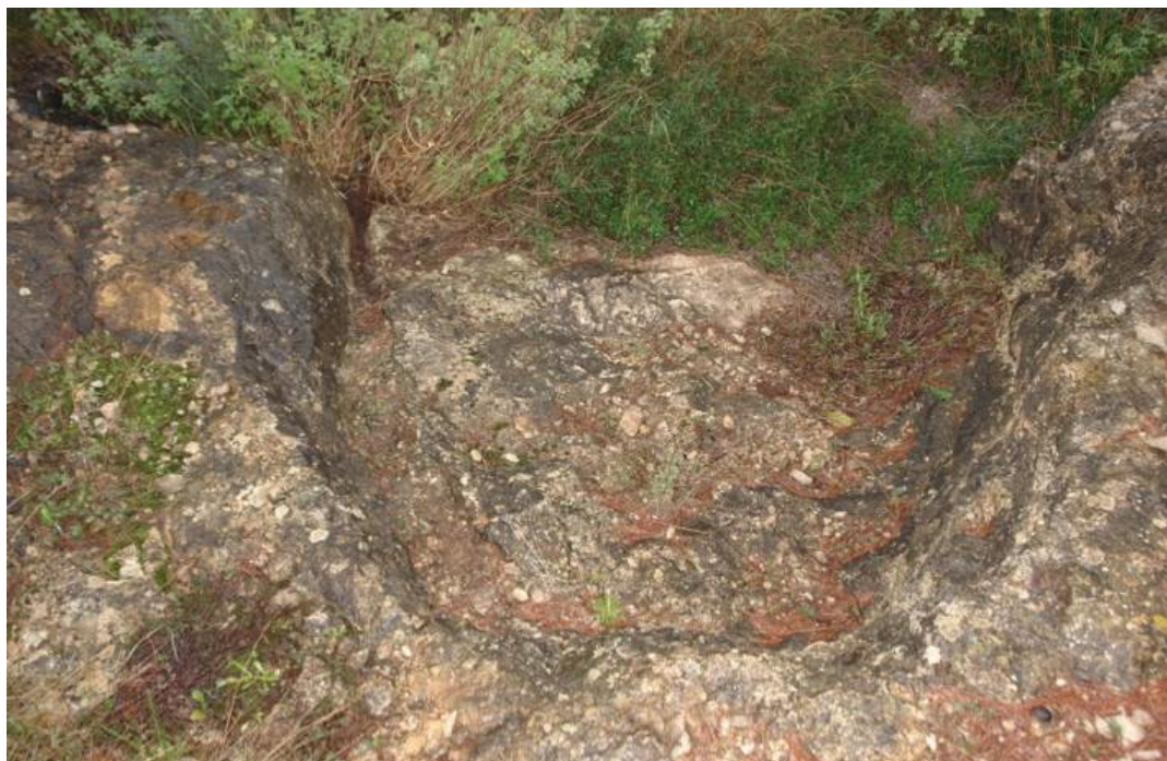
Semicírculo excavado para sacar un bloque en la pedrera de Godella
