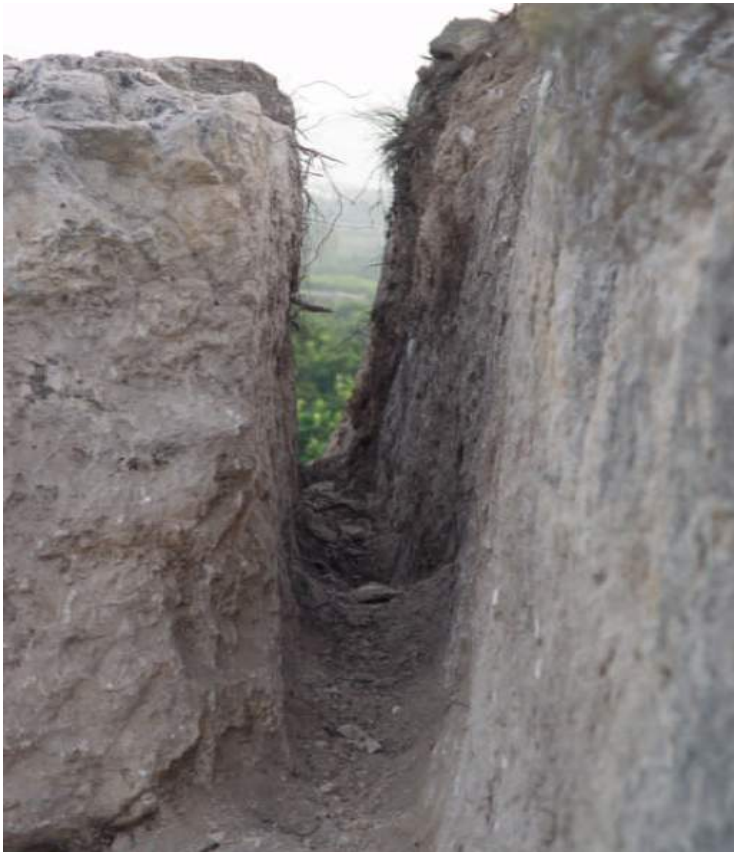
Enclava (regata) lateral de un bloque de la pedrera de l'Enova.
