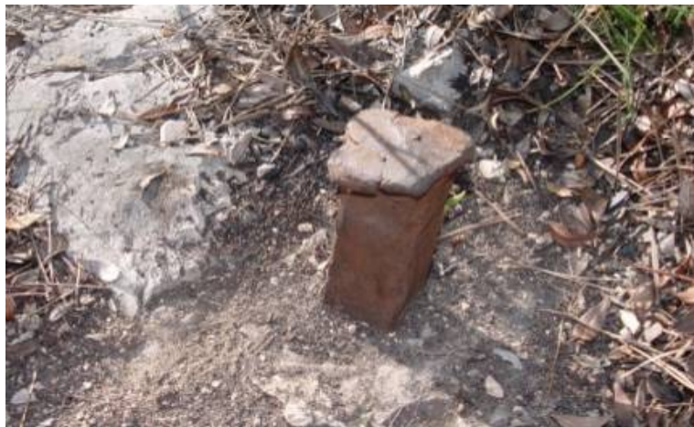
Cuña del siglo XIX de hierro, con sección cuadrada en unas canteras de Simat de la Valldigna.
