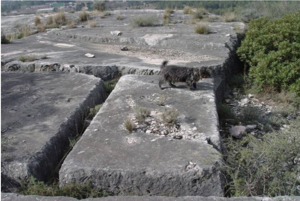
Bloques del siglo XIX-XX combinando la talla con herramienta a mano, con el hilo diamantado.
