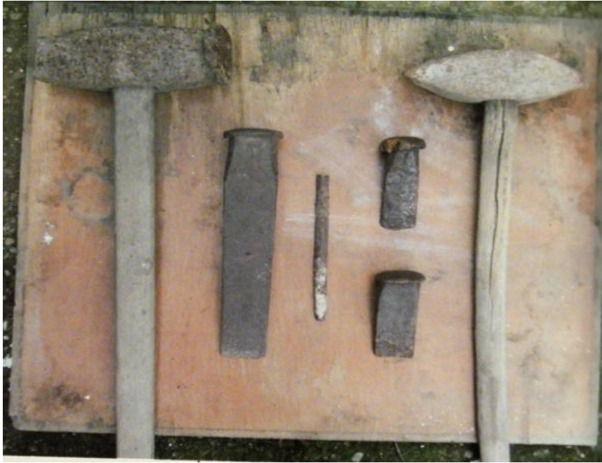
Herramientas de los pedrapiquers de Barxeta. Foto Abel Soler.
