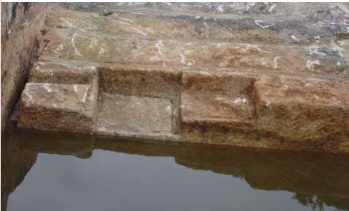
Bloques cuadrados extraídos a partir de un gran bloque rectangular.
