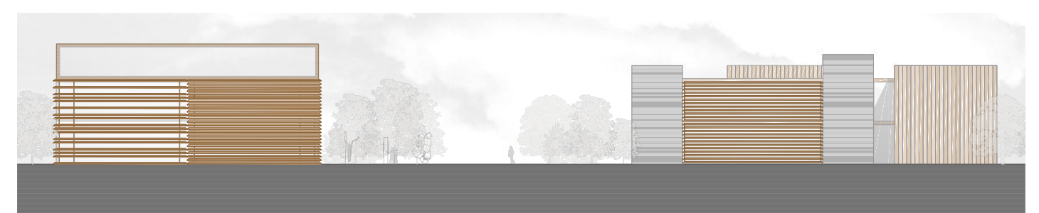
Mecanismos de control solar fachada sur (lamas horizontales)
