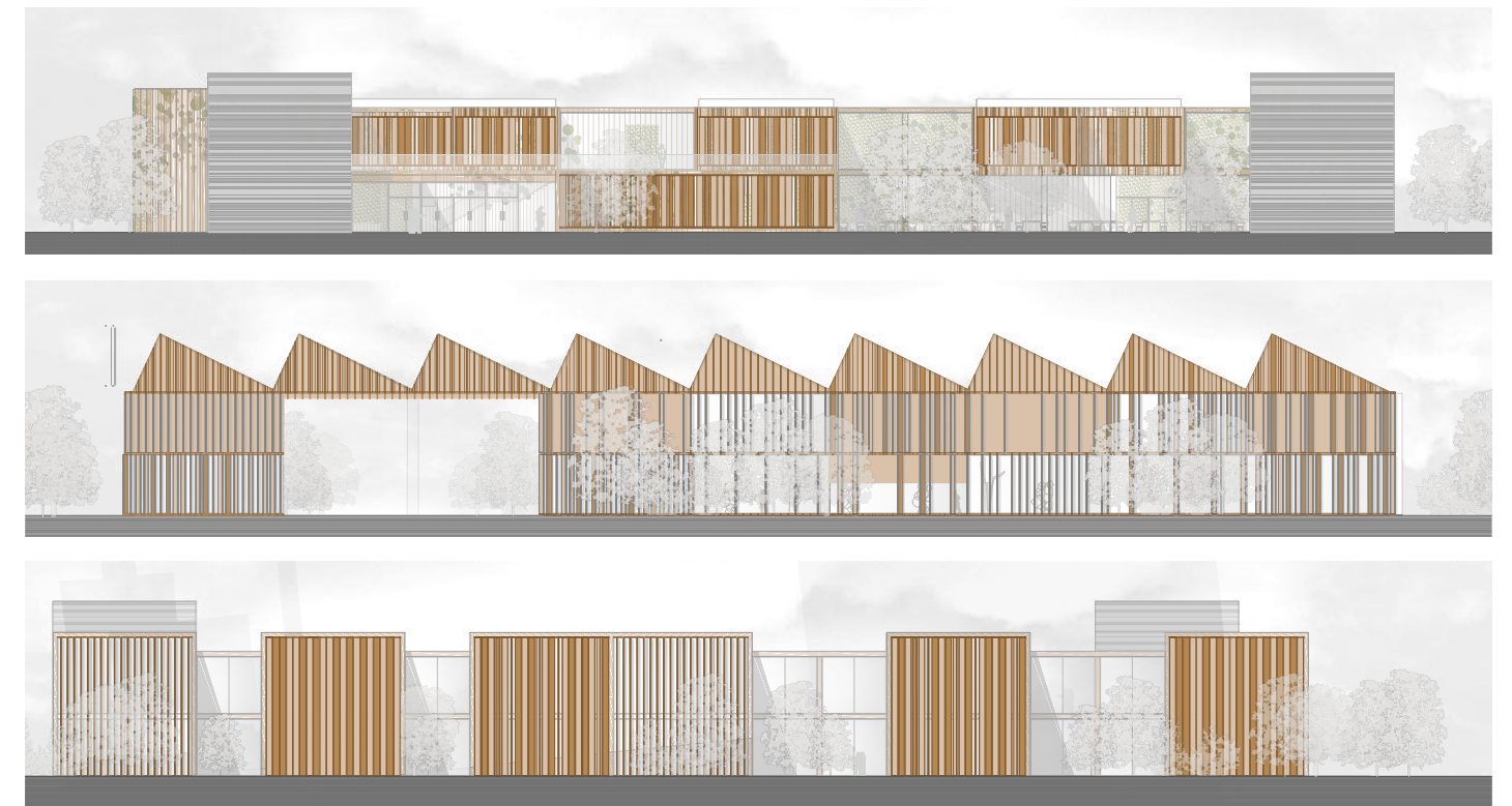
Mecanismos de control solar fachada este (lamas verticales)
