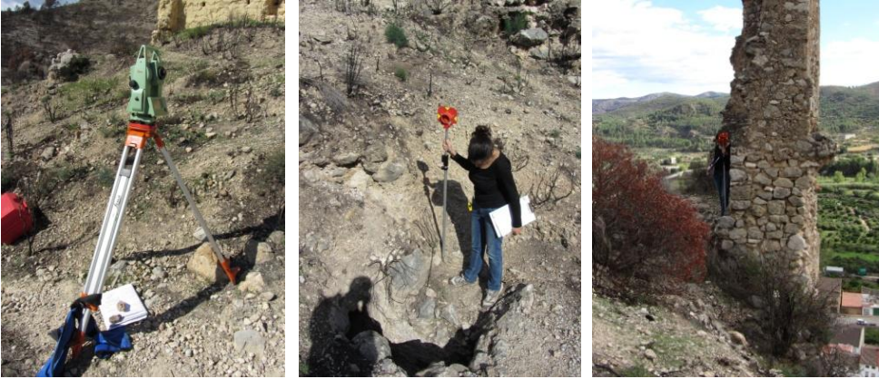
Imágenes 7.2, 7.3 y 7.4.- Estación total y toma de puntos.
