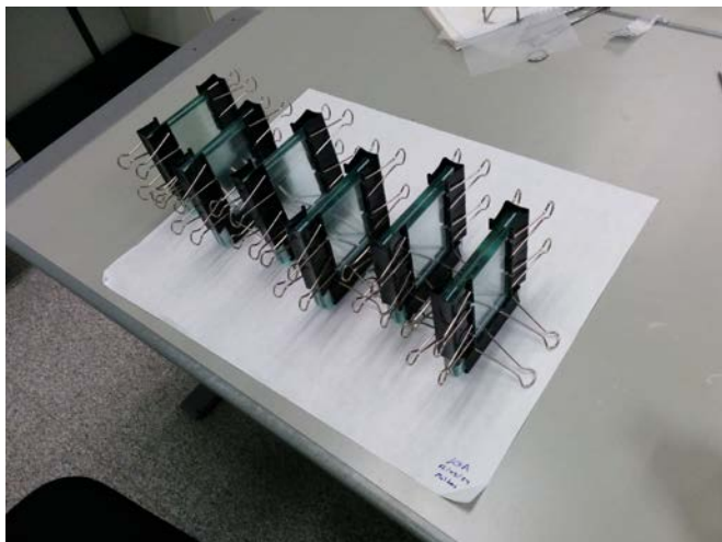
Figura 31 - Montaje de placas para polimerizado de films
