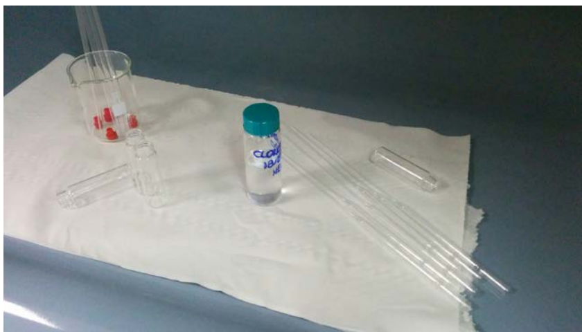
Figura 37 - Tubos de ensayo normalizados para H-R.M.N.
