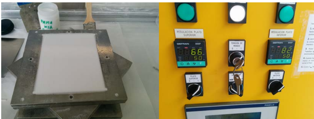
Figura 33 - Molde para la elaboración de plantillas y controles de mando de la prensa
