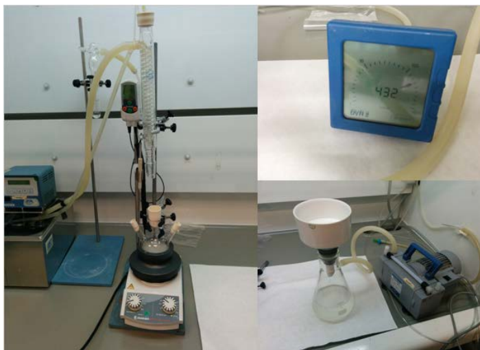
Figura 26 - Montaje de síntesis de Poli(ácido L-Láctido) diol - PLLA-diol
