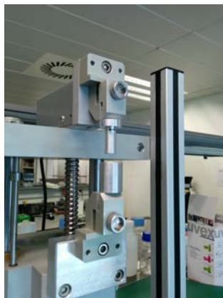
Figura 38 - Montaje del pistón de compresión en Microtest
