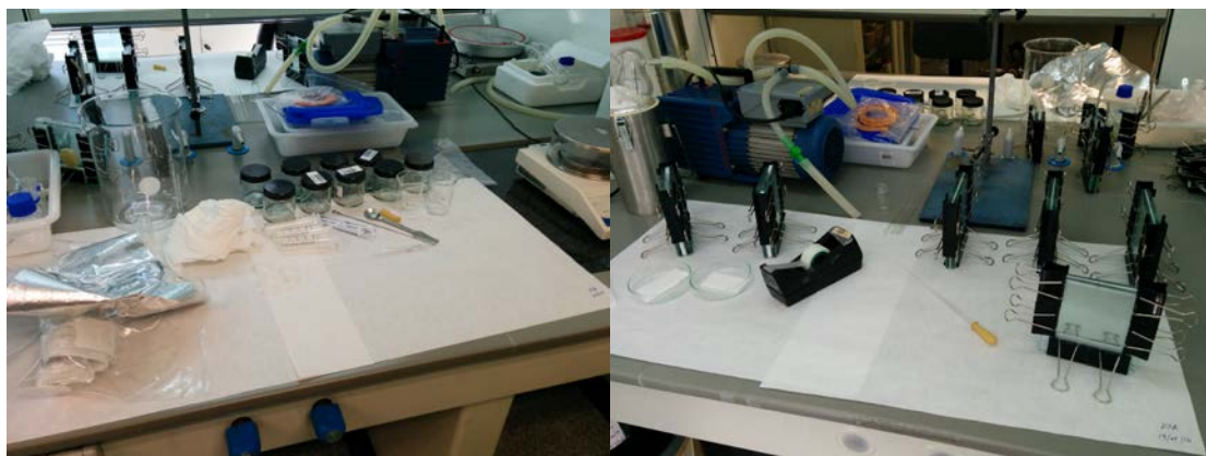
Figura 32 - Montaje del proceso de copolimerización de films de P(mLLA-co-HEA)
