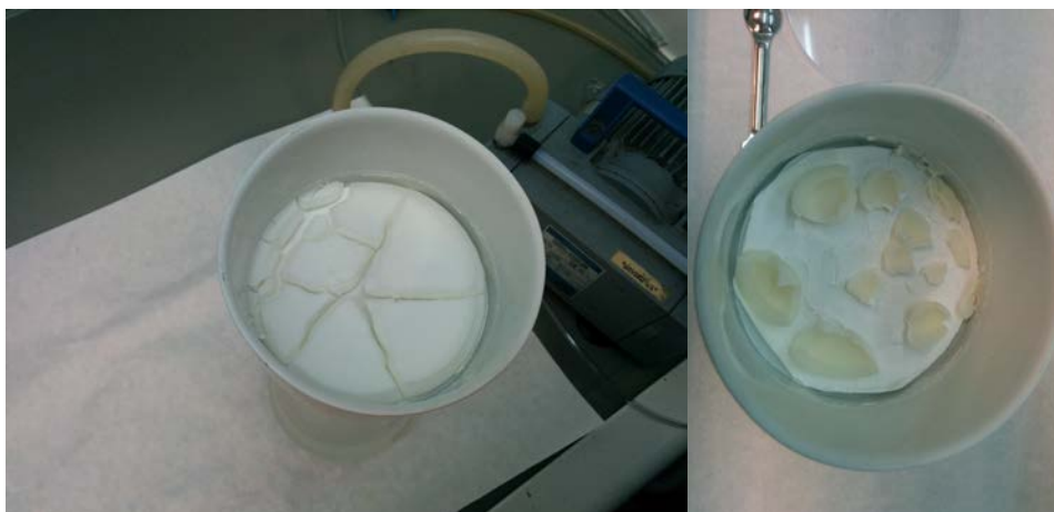
Figura 43 - Formación de virutas tras desecado en síntesis de PLLA-diol
