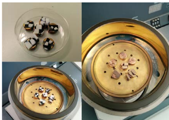
Figura 41 - Preparación de muestras para S.E.M.
