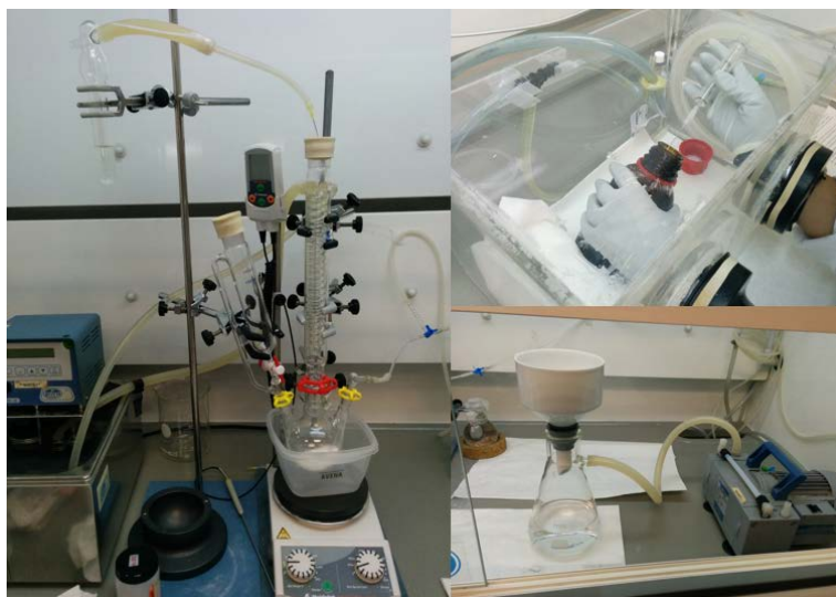
Figura 30 - Montaje de síntesis de macrómero [Poli(L-Láctido)] - mPLLA
