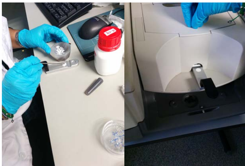
Figura 36 - Molienda y portamuestras - F.T.-I.R.
