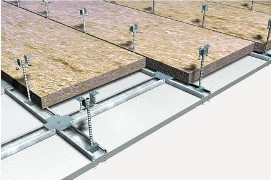
**Figura 51: Perspectiva aislamiento por el interior bajo forjado. Fuente Base de datos de precios de CYPE.**
