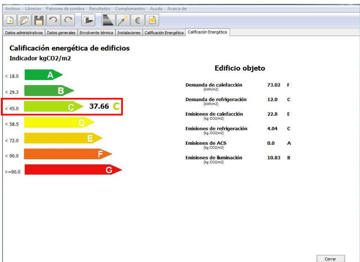
Fig. 18. Pantalla de resultados de la calificación energética con equipos de rendimiento de 250%
