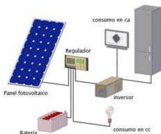
Fig. 15. Sistema fotovoltaico aislado. Fuente. Web: Autoconsumamos
