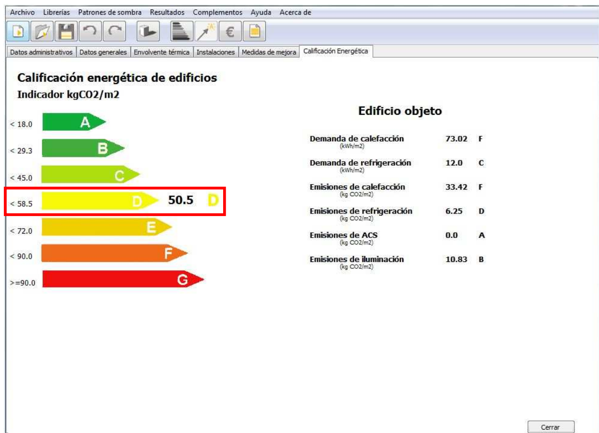
Fig. 17. Pantalla de resultados de la calificación energética con equipos de rendimiento de 180%
