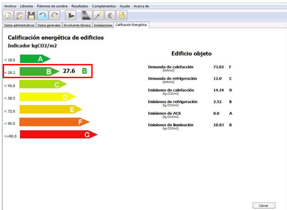
Fig. 19. Pantalla de resultados de la calificación energética con equipos de rendimiento de 400%
