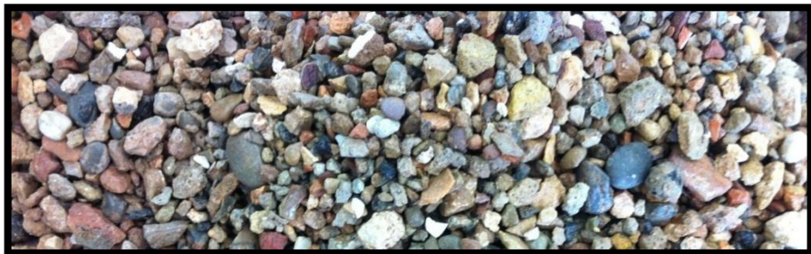
Fotografía 10 ÁRIDO RESTOS MIXTO
