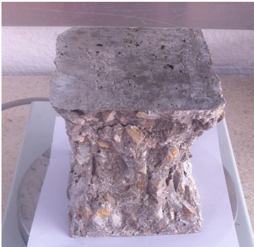
Fotografía Anexo 10 PROBETA HORMIGÓN PATRÓN CEM+CALIZO
