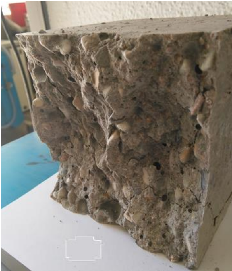
Fotografía Anexo 15 PROBETA DE HORMIGÓN BINDER+ÁRIDO LIMPIEZA DE CERÁMICA
