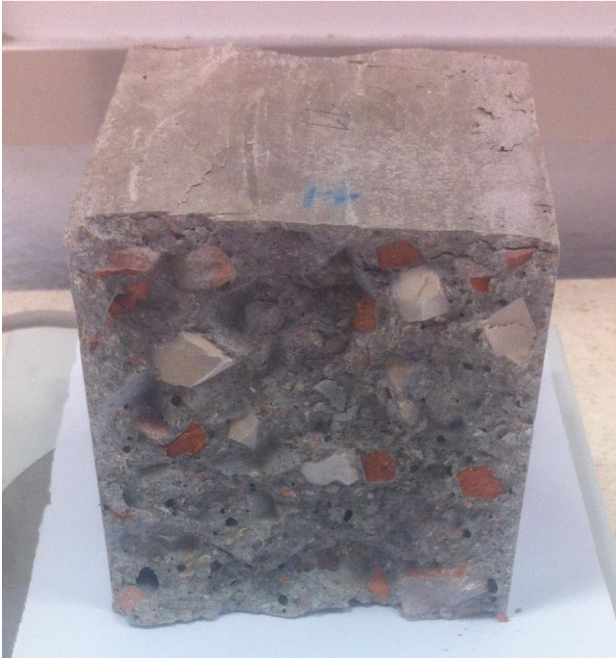
Fotografía Anexo 14 PROBETA DE HORMIGÓN BINDER+ÁRIDO CERÁMICO MIXTO
