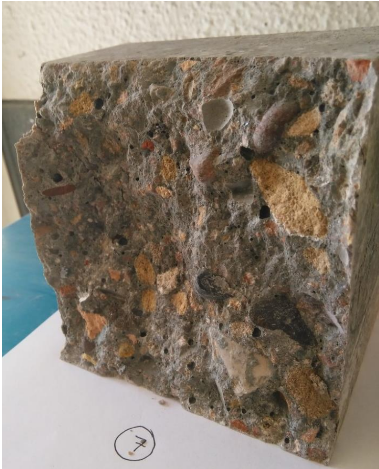
Fotografía anexo 13 PROBETA DE HORMIGÓN BINDER+ÁRIDO RESTOS MIXTO
