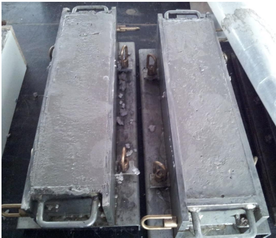
Fotografía Anexo 7 PROBETAS SIN DESMOLDAR
