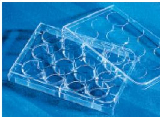
**Figura 6. Microplacas de 12 pocillos usadas para el ensayo de toxicidad aguda con *Daphnia magna* (Corning Inc).**
