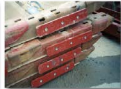
El ojal para transporte con cuña situado en la guía interior más corta, permite un punto de izado con menor altura
