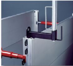
Apoyo de garra para evitar un hundimiento por resbalamiento de la unidad de entibación
