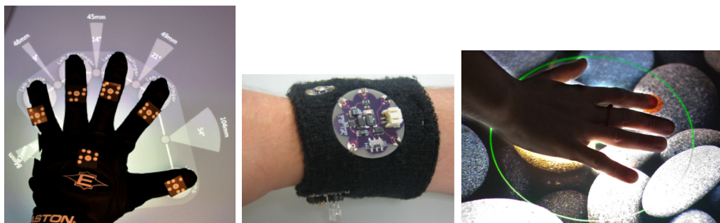
Figura 1.8: Soluciones hardware mediante wearables . A la izquierda, guantes equipados con etiquetas codificadas; al centro, idWristbands; y a la derecha, IR Ring. Ilustraciones tomadas de Marquardt y otros (2011), Meyer y Schmidt (2010), y Roth y otros (2010), respectivamente.
