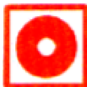
pulsador de alarma
