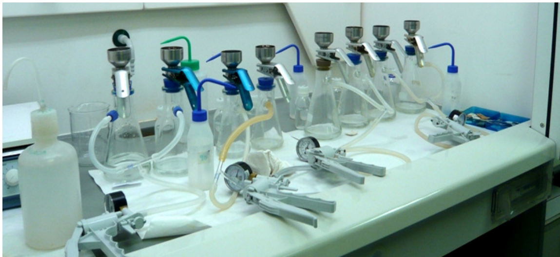
Figura 4.11. Proceso de filtración de las muestras para los recuentos fitoplanctónicos. (Grupo de Investigación de Ingeniería Hidráulica y Medio Ambiente, 2012).
