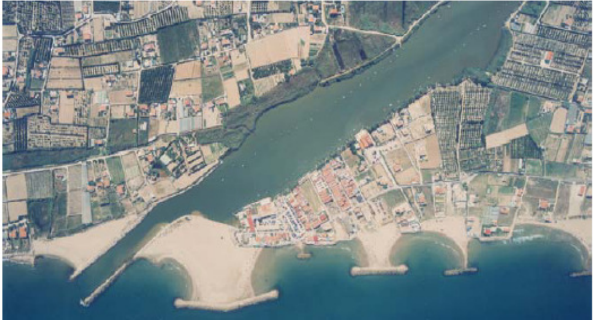
Figura 3.4. Vista del Estany tras su apertura al mar y la construcción de las escolleras. Foto de 1998 si bien en la actualidad presenta un aspecto similar. (CHJ, 2003)
