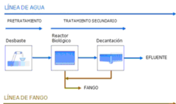
Figura 6.14. Fotografía y diagrama de bloques de la EDAR del Estany de Cullera (EPSAR, 2013).
