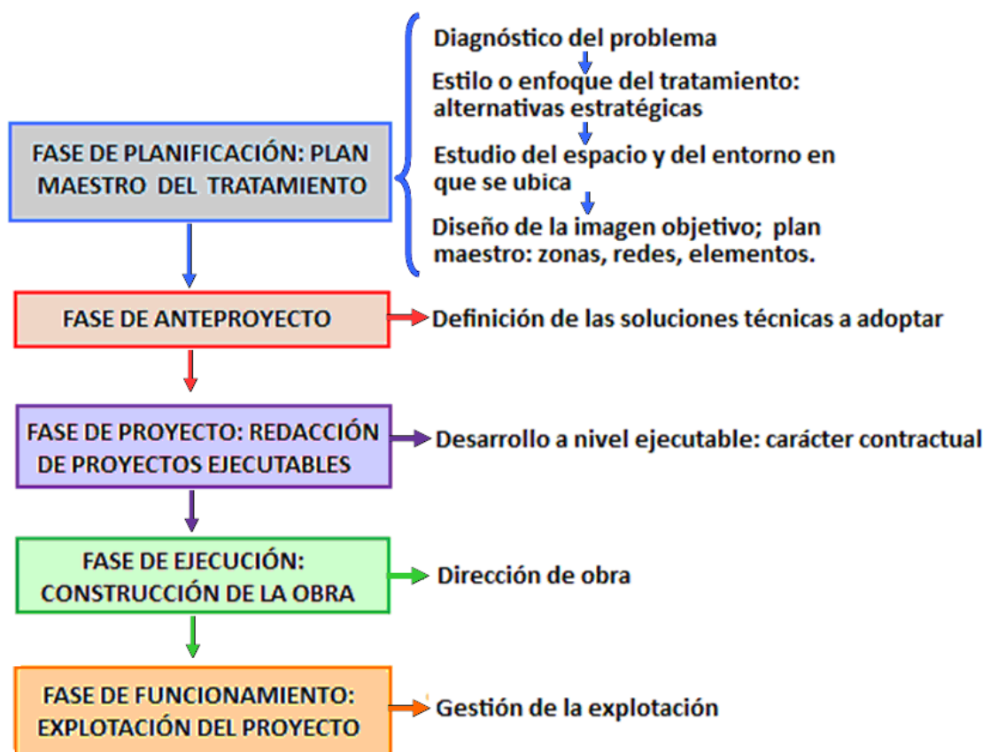
Figura 6.2. Fases por las que pasa el tratamiento de un espacio degradado y contenido de cada una de ellas (Gómez Orea, 2004).
