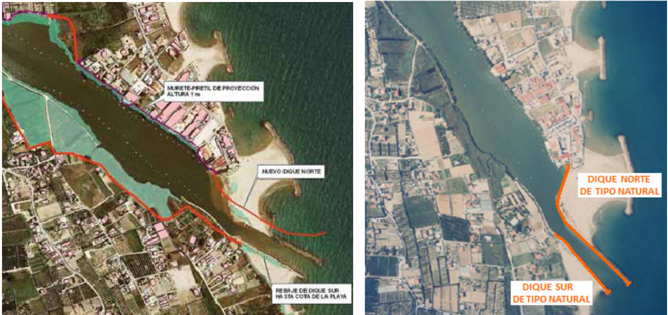
Figura 6.26. En la imagen izquierda aparecen las medidas que la CHJ quiere hacer en la desembocadura del Estany y en la imagen derecha la nueva alternativa propuesta (diques de tipo natural).
