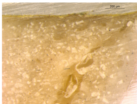
Fig. 58. Fotografia microscòpica del estrats de suport, preparació i làmina d'or
