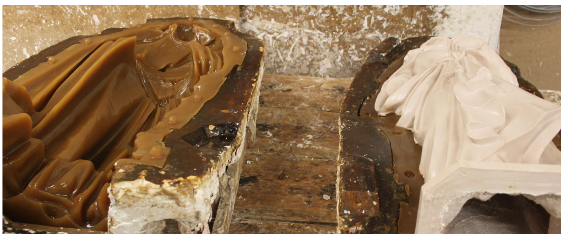
Fig. 14. Vista general d'un motle obert on podem veure el positiu
