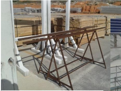
Ilustración 27. Caballetes para la armadura. Fuente: Propia.
