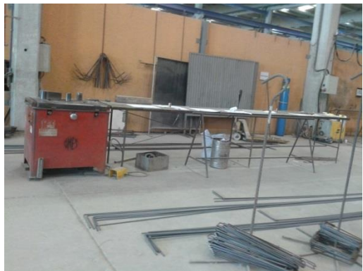
Ilustración 13. Dobladora de armaduras. Fuente: Propia.
