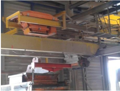
Ilustración 15. Cubilote hormigonado y vagoneta mono-carril. Fuente: Propia y Bibliografía 1.
