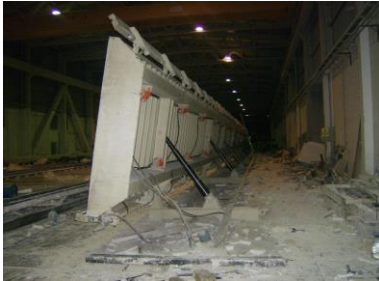
Ilustración 33. Vuelco de bancada. Fuente: Bibliografía 1.
