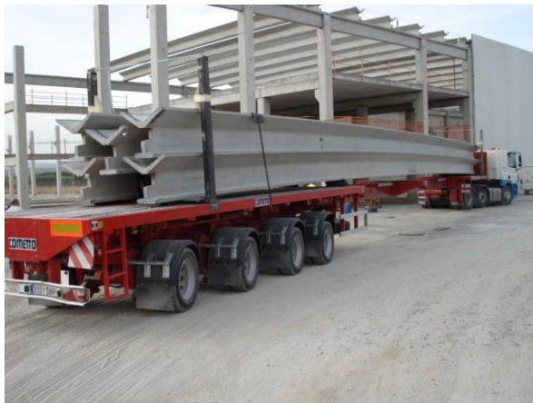
Ilustración 40. Plataforma extensible. Fuente: Transgruas
