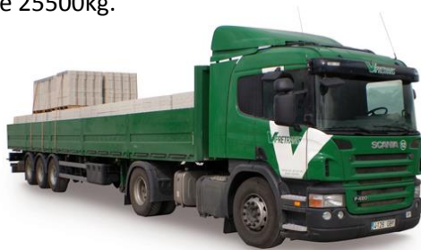
Ilustración 41. Plataforma no extensible. Fuente: Vipreluc.
