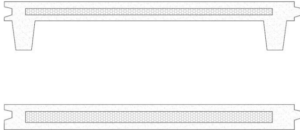
Detalle 31. Paneles de cerramiento. Fuente: Propia.
