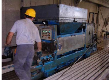
Ilustración 15. Cubilote hormigonado y vagoneta mono-carril. Fuente: Propia y Bibliografía 1.
