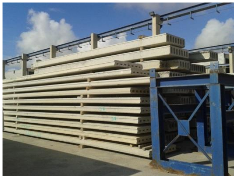
Ilustración 17. Acopio losas alveolares. Fuente: Propia.
