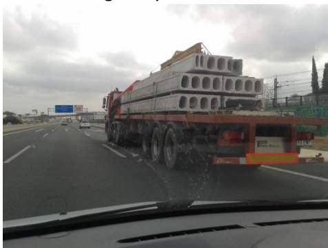
Ilustración 44. Camión autocargante. Fuente: Propia.
