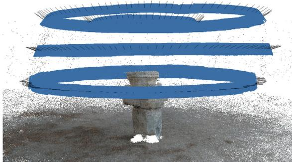
Fig. 4.24. Anillos horizontales formados por las diferentes fotografías de la pieza B2A.1.
