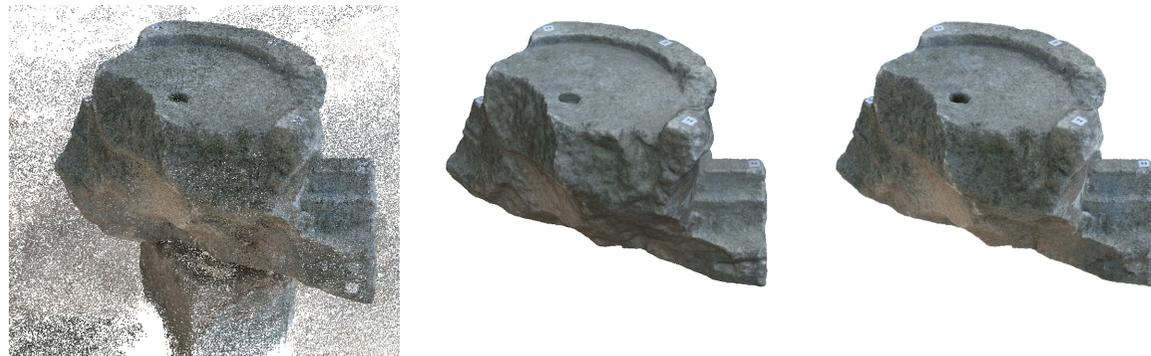
Fig. 4.27. Distintas fases del cálculo dentro de Photoscan. Cálculo de la alineación, cálculo de la mesh y texturizado.
