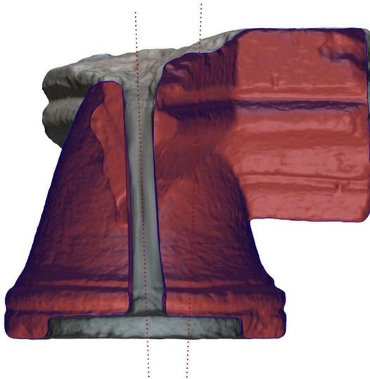
Fig. 6.11. Sección de la clave secundaria por la mitad de su cuerpo central.
