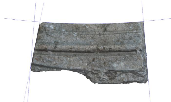
Fig. 7.32. Dovel de arco de cabeza B1B.2. Análisis de los ejes principales mediante la aplicación de Rapidform, presenta uno de sus lechos con un ángulo diferente a la radial.
