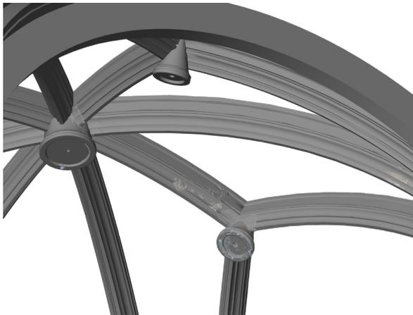
Fig. 8.31. Reconstrucción virtual de las claves. Superposición de las mallas de las claves idealizadas con las claves recuperadas.
