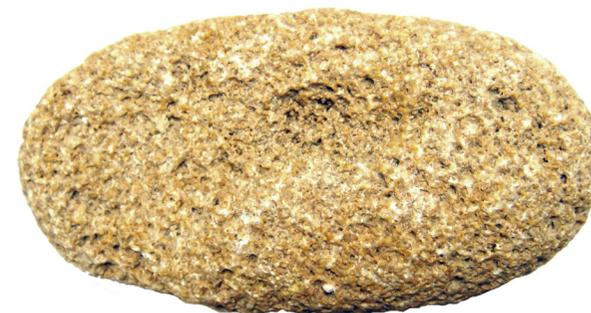
Fig. 4.08. Muestra de toba calcárea, recogida en la Cova Tallada para su comparación con las dovelas encontradas en el castillo de Denia.
