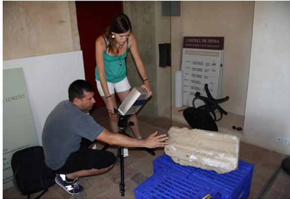
Fig. 2.28. Proceso de escaneado de la dovela para el estudio comparativo con Photoscan.
