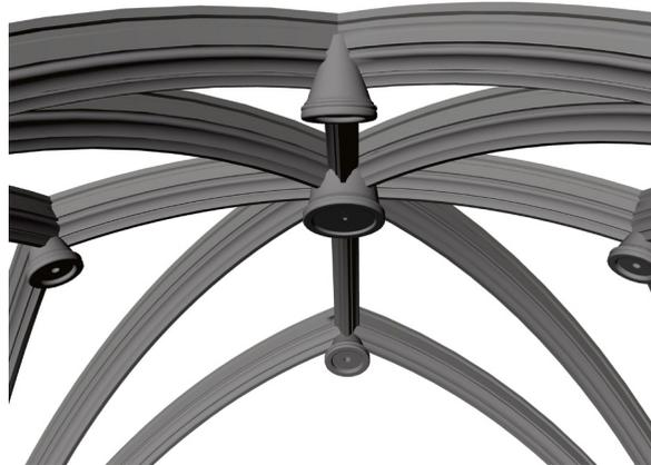
Fig. 8.32. Reconstrucción virtual del esqueleto de la bóveda.
