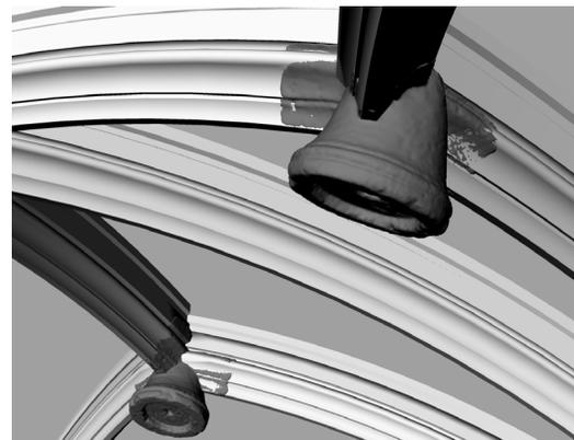
Fig. 8.19. Unión de los terceltes con la clave secundaria.
