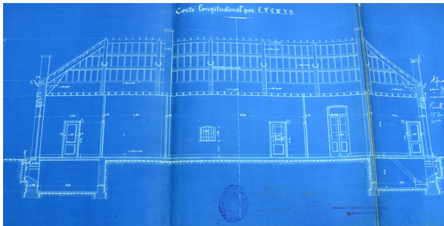
Imágenes V-21 a V-22. Plano planta y sección longitudinal para estación tipo de segunda categoría del proyecto de la línea de Calatayud al Grao de Valencia. 1897. Ingeniero: Francisco Domendonia. Fuente: Archivo Histórico Ferroviario. I-0113-001.
