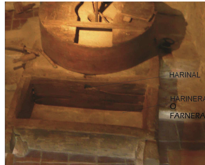
Fig. 8.1-17 Detalle del harinal y harinera del Molí de Toni, en Culla, provincia de Castellón. 8.1-7
