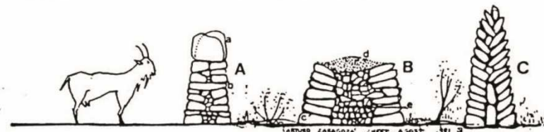
Fig. 6.1.1.4-1 Paredes de piedra en seco según Arturo Zaragoza 6.1.1.4-1
