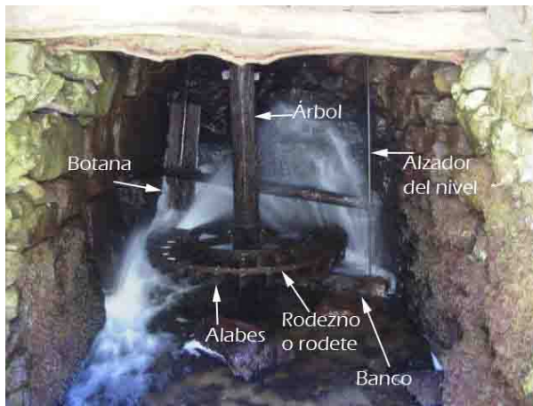
Fig. 8.2 Partes del "motor" del molino. Descripción propia. 8.2.2
