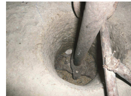
Fig. 8.1-12 Detalle del tramo superior o palahierro. Se observa el ojo de la muela y dentro del mismo el nadilla. 8.1.5
