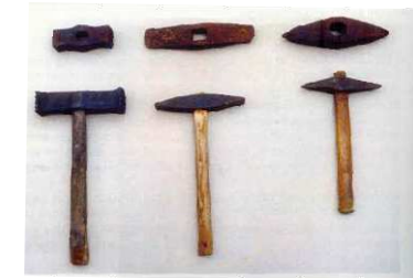
Fig. 8.2-4 Herramientas de picar la mola. 8.2.4
