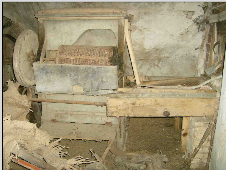
Fig. 14 Maquinaria de la limpia en planta primera
