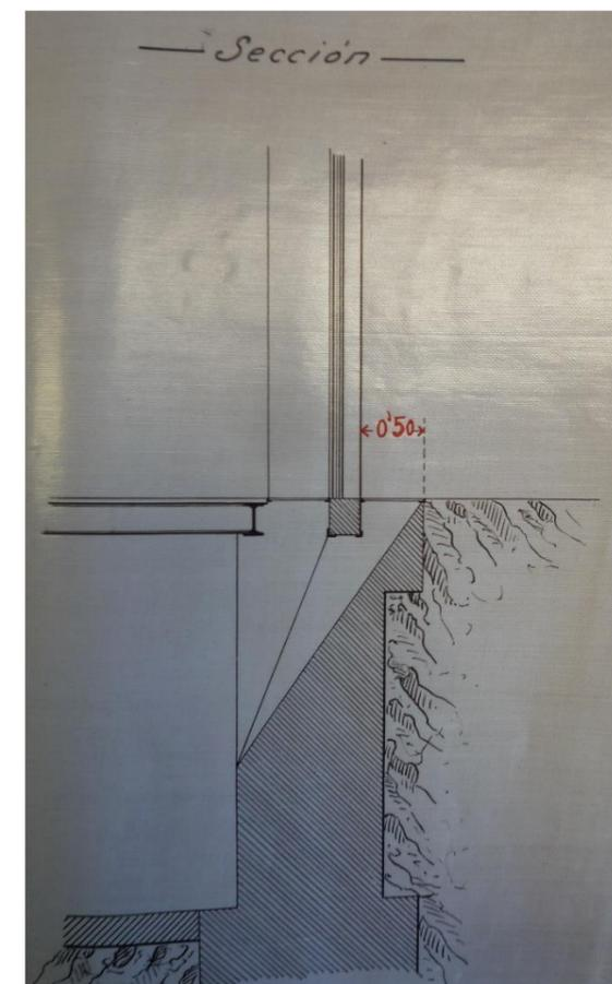
Ilustración 36. Detalle en sección de lucernario de sótano
