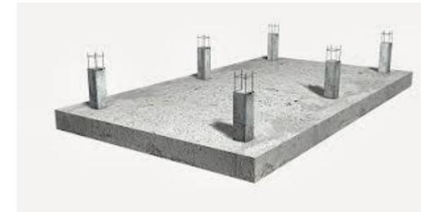
Ilustración 91. Ejemplo de losa de cimentación
