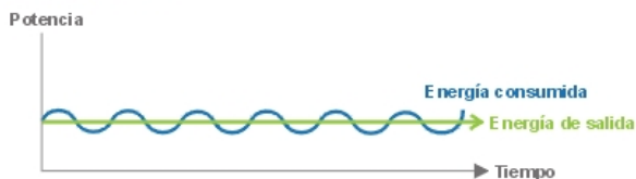
Figura 81: Comparativa sistema inverter y convencional.
