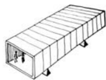
VIGA HABITABLE TRABAJANDO COMO JACENA APOYADA Y CON POSIBILIDAD DE GRANDES VOLADIZOS
