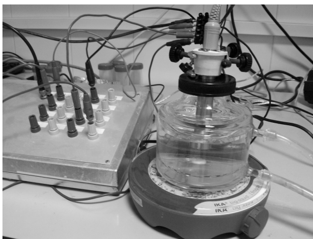
Figura 8. Equipamiento experimental para medidas con la lengua electrónica potenciométrica.
