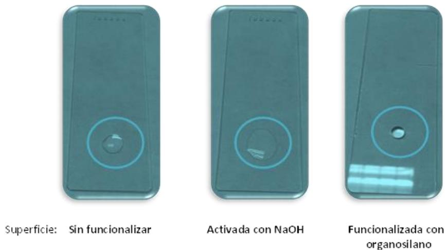
Figura 7 Ángulo de contacto de una gota de agua en la superficie antes de la activación, después de la activación y después de la funcionalización.
