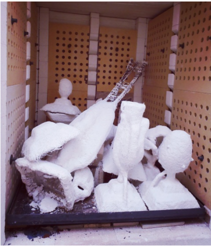
Piezas dentro del horno de descere.
