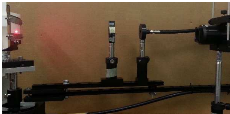
Fig 23. Fotografía del sistema de medida angular
