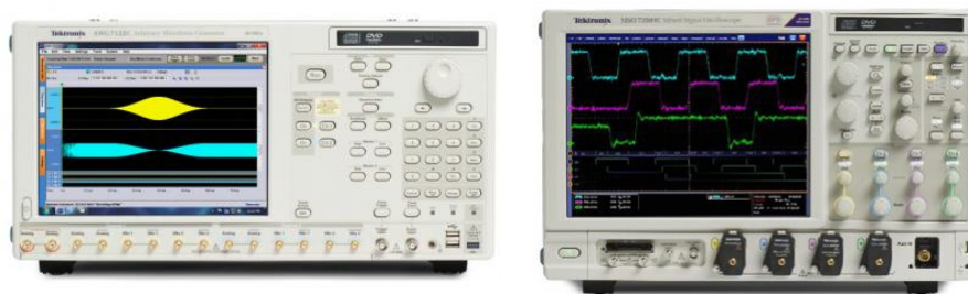
(a) (b) Fig. 6. Equipos generador AWG7122C (a) y receptor DPO72004C (b).
