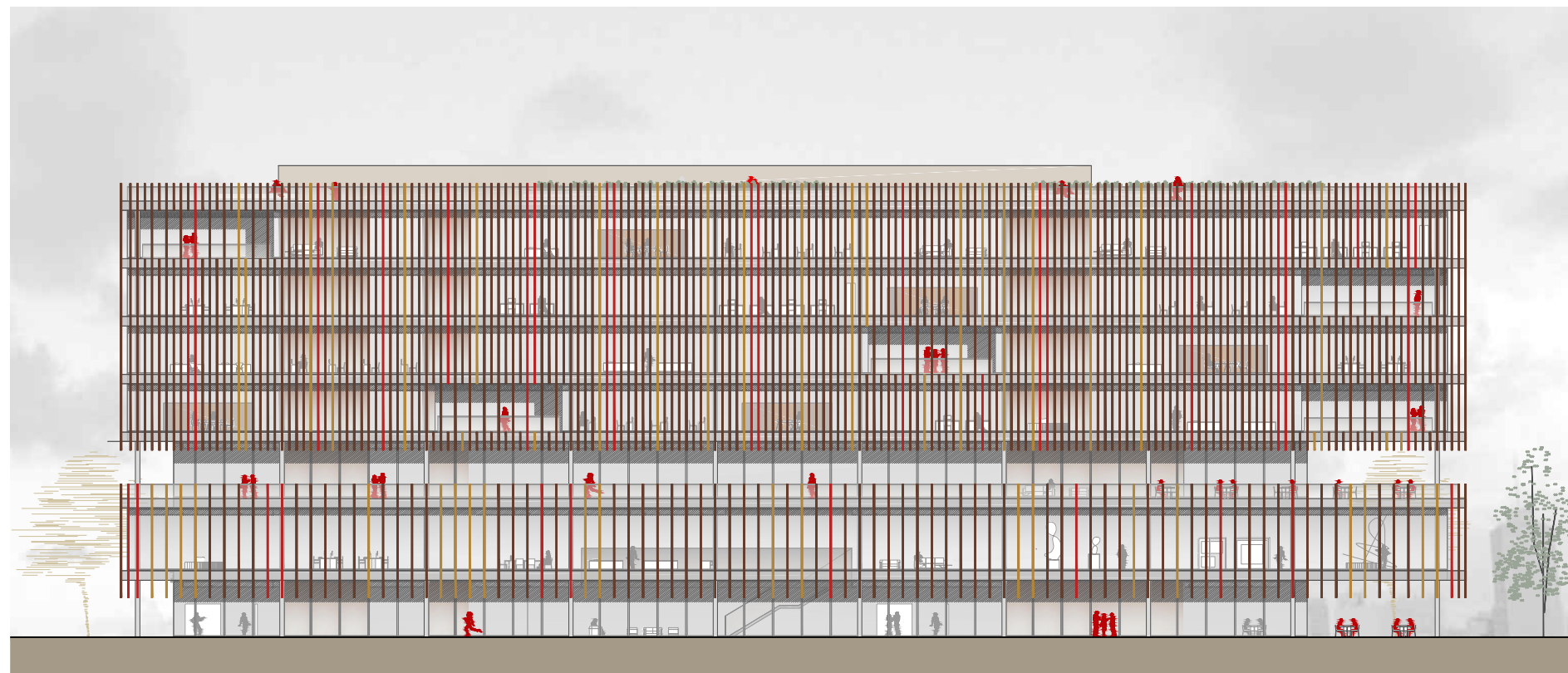
uso de acero corten en fachada este
