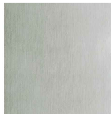
acabado de la chapa metálica que recubre los frentes de forjado y voladizos
