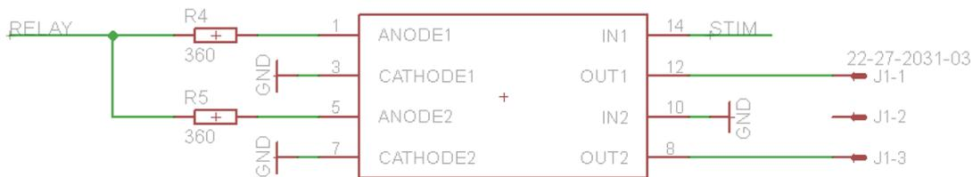
**Ilustración 18. Conexión de los relés del C347S.**
