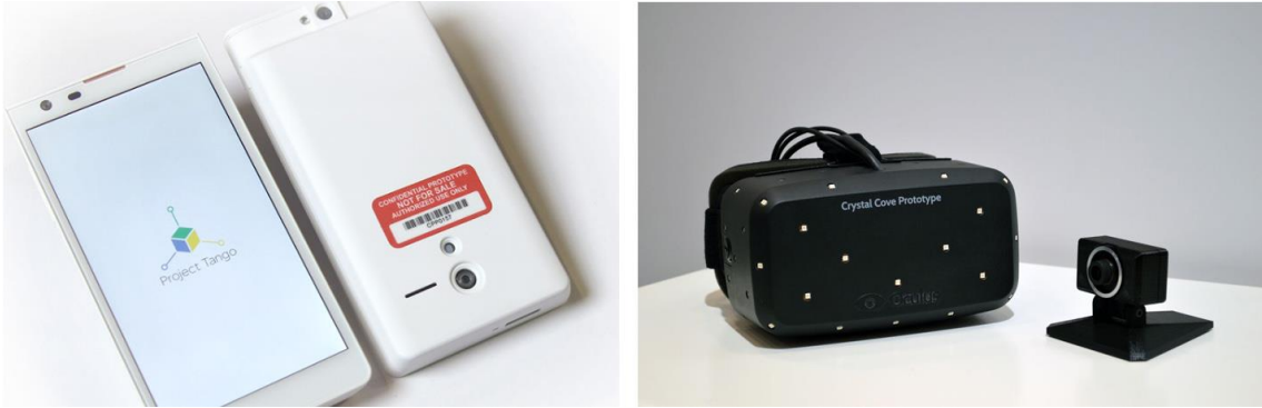
Figura 4 Prototipo del dispositivo móvil con tecnología Tango a la izquierda. A la derecha: Oculus Rift y los 40 LED's infrarrojos mediante los que se realiza el seguimiento de los movimientos de la cabeza del usuario.
