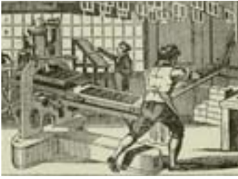
Prensa de Stanhope que supuso la posibilidad de imprimir de un solo golpe. 1804
