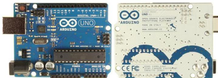
Figura 3. Vista frontal y trasera Arduino UNO Rev3 [1]
