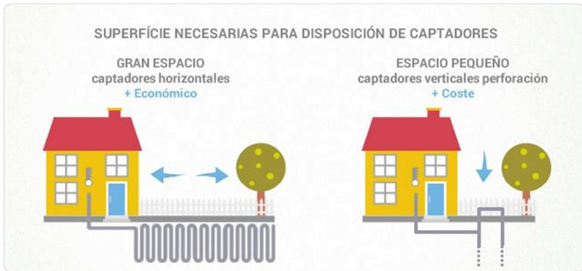
Figura 4.19: Sistemas de colectores para energía geotérmica
