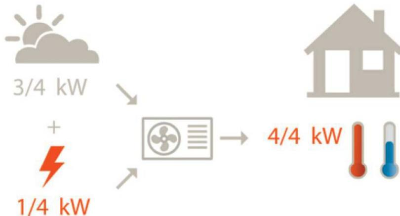
Figura 4.37: Origen energético de la bomba de calor
