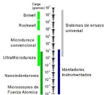
**Figura 3.8.** Escala de cargas de indentación según el tipo de técnica empleada. [17]
