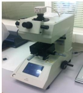
**Figura 3.10.** Microdurómetro Shimadzu Modelo HMV-2 con microscopio integrado utilizado para los ensayos de dureza Vickers y tenacidad por microindentación.
