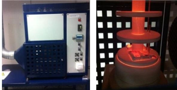
**Figura 3.3.** Imágenes del equipo usado para fatiga térmica.
