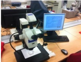
**Figura 3.5.** Microscopio Leica modelo KL 1500 LCD (lupa para estereoscopia).
