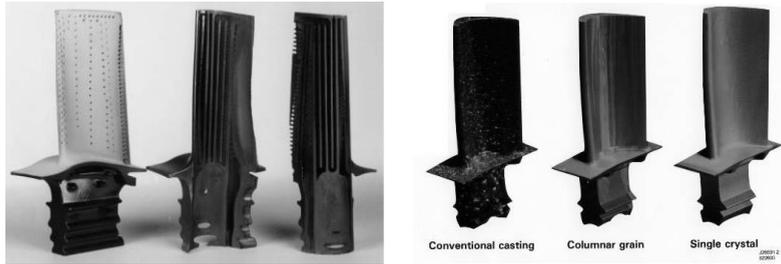
**Figura 1.2.** Álabes de turbina a) Estructura interna de álabe de alta presión de la turbina. b) Álabes de fundición convencional, grano columnar y mono cristal. [2].
