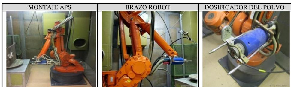
**Figura 3.1.** Equipo usado en la técnica de proyección térmica por plasma atmosférico APS.
