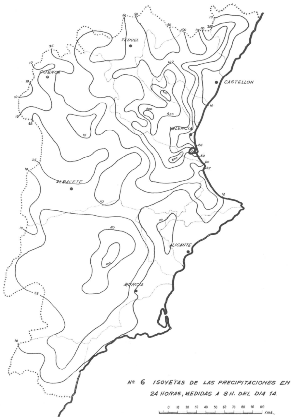
Il·lustració 35. Isohietes de precipitació en 24h, mesurades a 8h del dia 14. Font: GARCÍA, V., CARRASCO, A., (1958).
