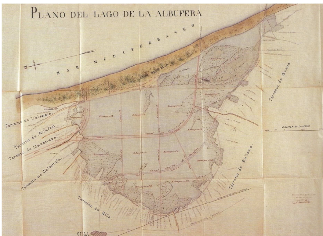
Il·lustració 27. Planta del Llac de l'Albufera amb l'entroncament del Nou llit del riu Túria, que inclou les obres projectades per a la seua dessecació: canals de circumval·lació, canal de conducció, canal de desaiçgüe i estany's. LLORENS I FERNÁNDEZ DE CÒRDOVA, J., (1885). Arxiu: VEGESTU I MEDITERRÀNIA. Font: SORRIBES, J.,
