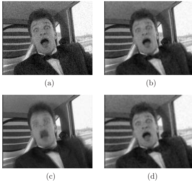
Figura 4.20: Comparación entre filtrados: (a)Secuencia original ruidosa: carphone+ruido. (b)Filtrado espacio-temporal ( M \times N = 3 \times 3 y L = 9 ). (c)Filtrado temporal ( L = 9 ). (d)Filtrado espacial ( M \times N = 3 \times 3 ). Para comparar el resultado del filtrado espacio-temporal (b) y el temporal (c) podemos fijarnos en la cortinilla del fondo, que es estática, y en ambos resultados está nítida, mientras que la cara del personaje, que es una zona en movimiento es la que está emborronada, mucho más en el caso del filtrado temporal (c). Al comparar ahora con el filtrado espacial, vemos que éste emborrona por igual zonas estáticas (cortinilla) y dinámica (cara), y este emborronamiento es el máximo que introduce el filtrado espacio-temporal (caso cuando existe movimiento); esto puede comprobarse en la cara del personaje, que para ambos filtros (espacial y espacio-temporal) está igual de borrosa.
