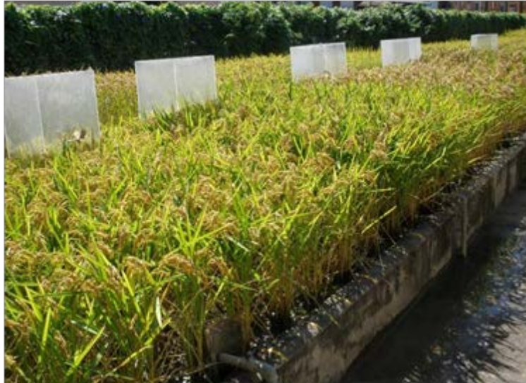
Figura 12. Cámaras de metacrilato colocadas en las balsetas para la determinación de las emisiones de metano
