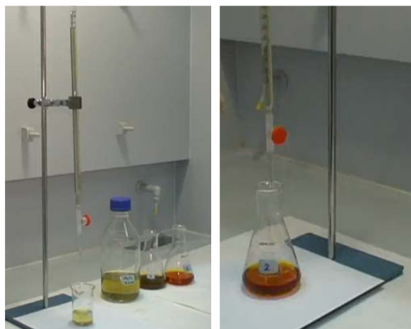
Figura 10. Valoración del dicromato potásico con sulfato ferroso para la determinación del C orgánico total
